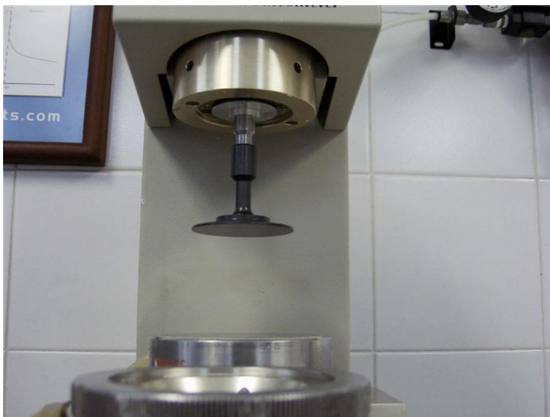
Figura 18. Reómetro TA Instruments Inc., adaptado con la geometría de Placa Paralela.
