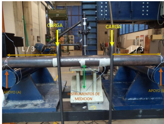
Figura 38. Representación de la Viga Simple lista para ensayo a flexión
