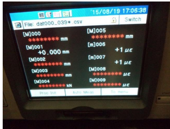
Figura 18. Puertos 6 y 7 Donde están Conectadas las Galgas Habilitadas.
