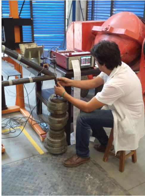
Figura 28. Montaje del Respectivo Equipo de Medición y Selección de los Pesos.
