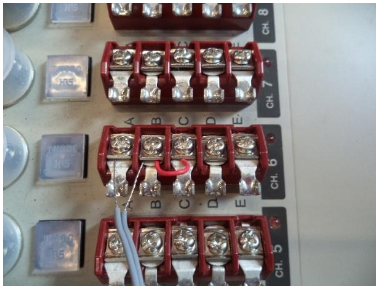
Figura 8. Modelo de Conexión de la Galga al TDS – 530.
