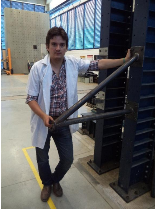
Figura 27. Estructura Final Soldada en todos sus Extremos.
