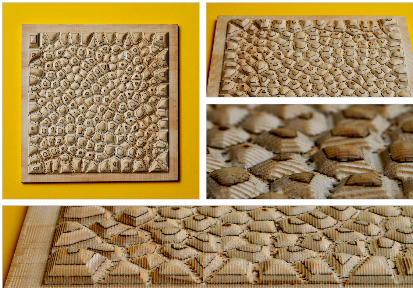
Especie: Artocarpus heterophyllus Tipo de textura: estándar Material: madera contrachapada (plywood) o también conocido como Triplex Tecnología: fresado por CNC Dimensiones: 200 x 200 x 15 mm
