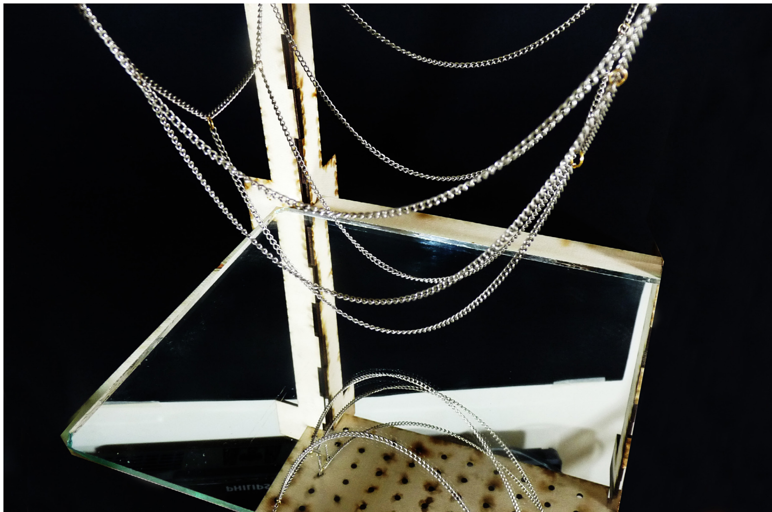
Figura 22. Técnica física similar a la utilizada por Gaudí en la Sagrada Família. Consta de cadenas con un espejo en la parte inferior. Maqueta de Valeria Londoño. Fotografía de Ever Patiño.
