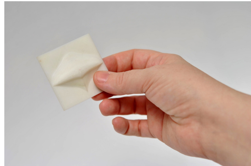
Figura 168. Impresión 3D de módulo de la textura basada en la especie Pinus pinea , a través de la tecnología FDM, impresora Zortrax M-200 y con el material polimérico ZABS plus. Dimensiones 50x50x9 mm. Fotografía de David A. Torreblanca-Díaz.
