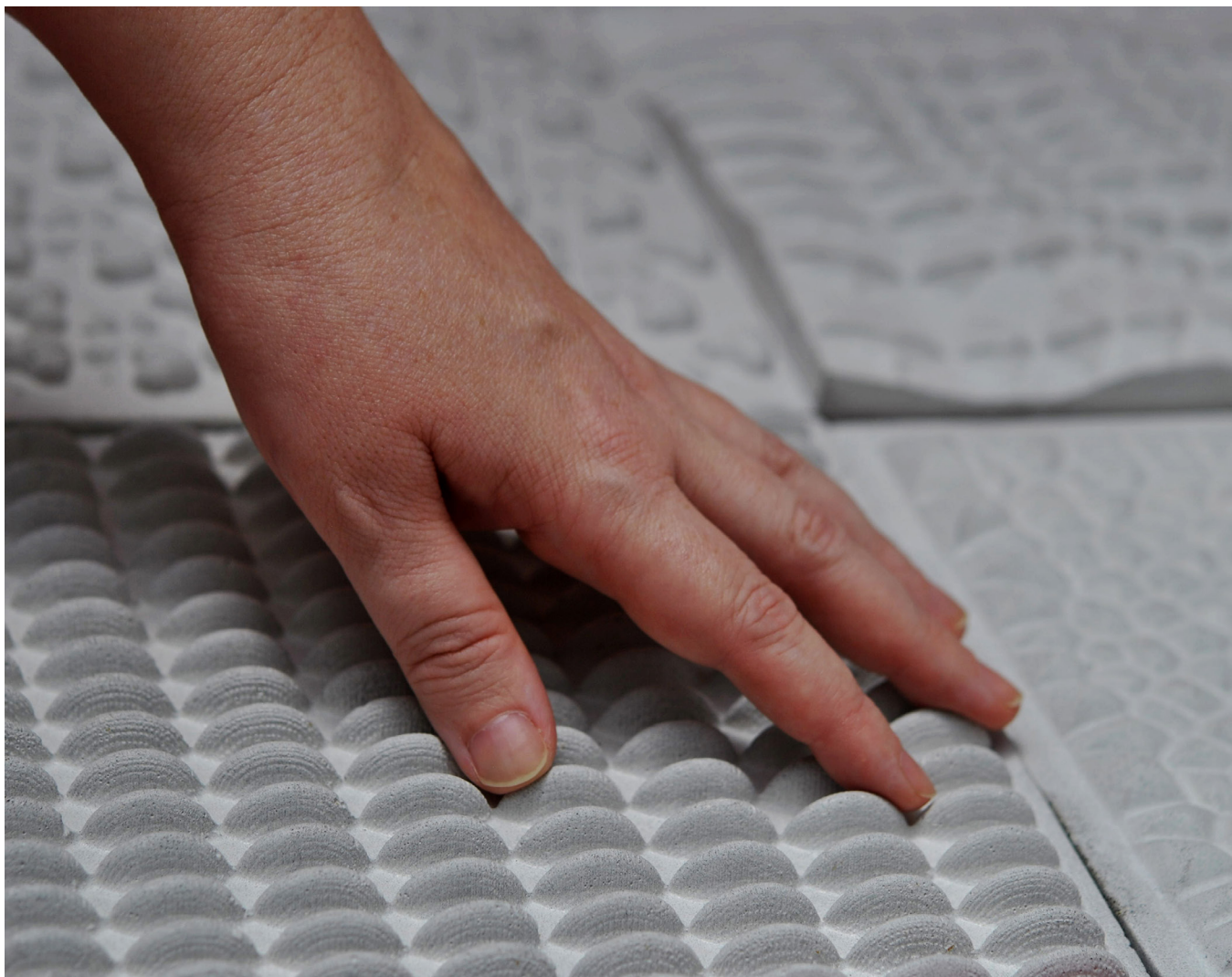
Figura 164. Interacción con muestras de concreto con cemento Portland blanco, texturas basadas en diferentes especies vegetales presentes en el Valle del Aburrá. Fotografía de David A. Torreblanca-Díaz.
