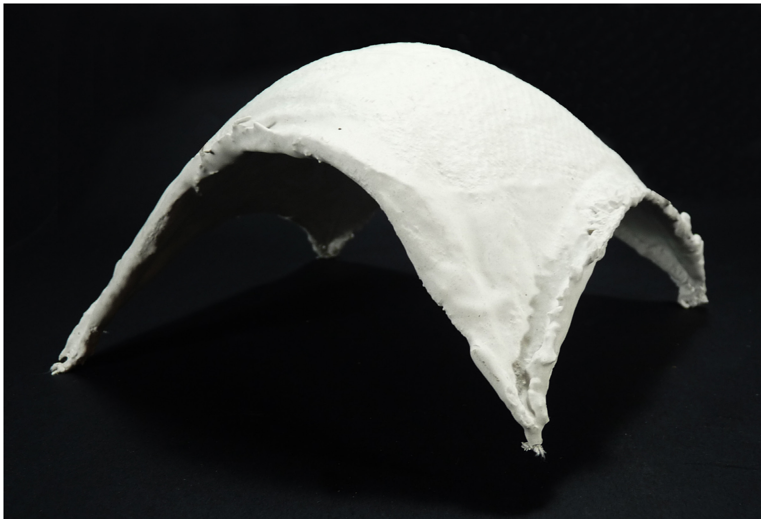
Figura 23. Superficie formada por un textil impregnado en yeso, en el que la acción de la gravedad derivó en curvas catenarias. Luego de secado el textil se invirtió y se convirtió en una cáscara estructural. Fotografía de Ever Patiño.
