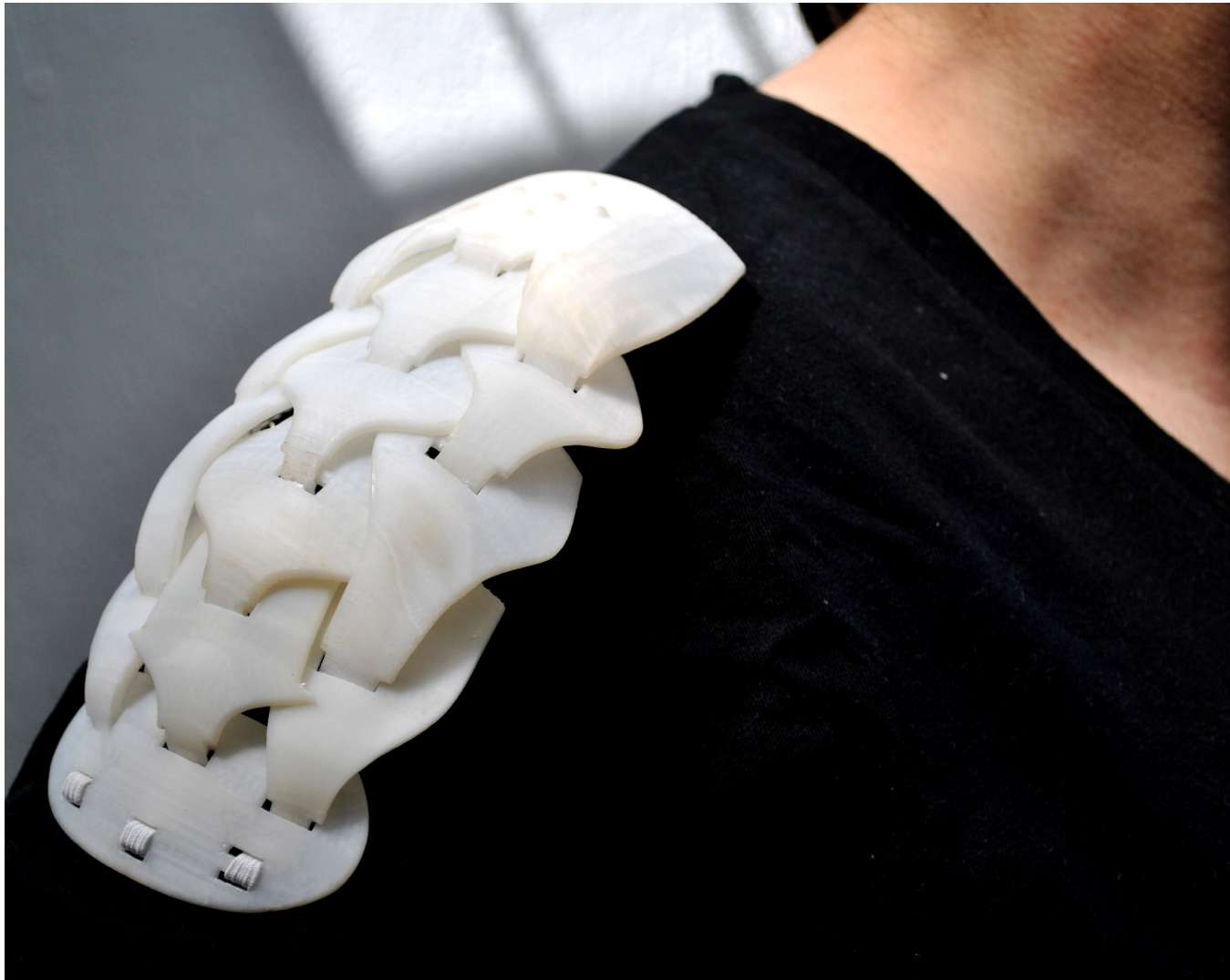
Figura 200. Prototipo focalizado construido con la tecnología FDM. Diseño de Juan Diego Buriticá. Fotografía de David Torreblanca-Díaz.
