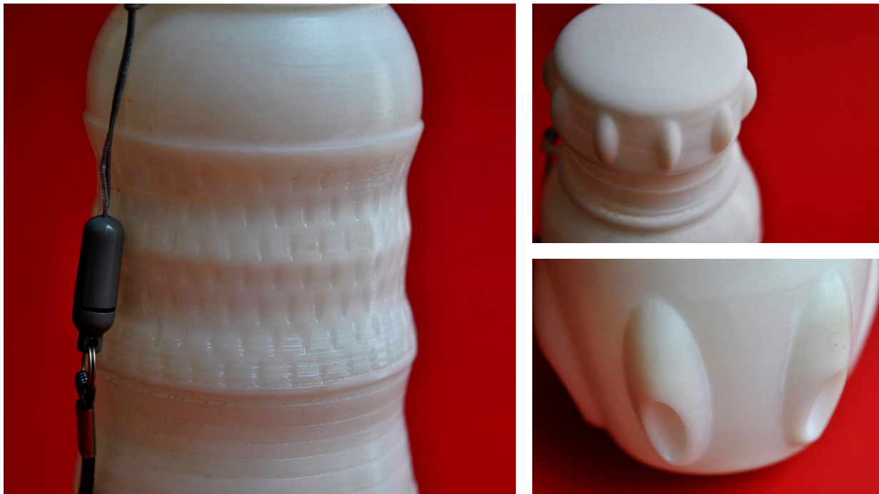
Figura 193. Detalle de texturas del prototipo de envase para suplementos dietarios. Prototipo construido con la tecnología FDM, a través de la impresora Zortrax M-200 y con el material polimérico ZABS plus. Fotografías de David A. Torreblanca-Díaz.
