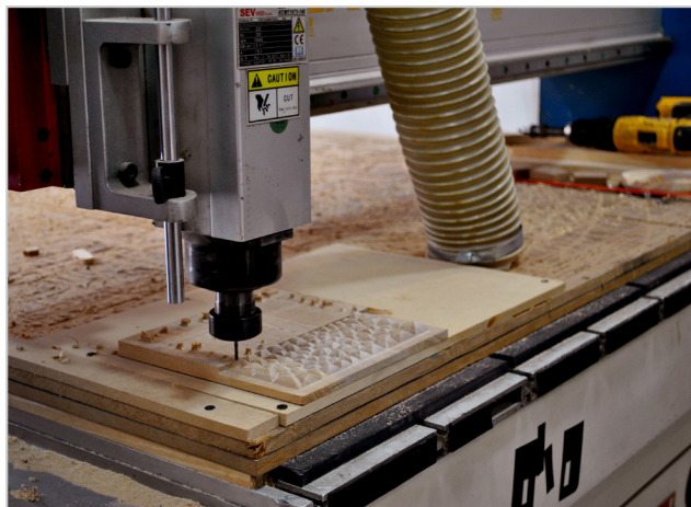
Figuras 119, 120, 121 y 122. Secuencia del proceso de materialización con la tecnología de fresado por CNC. Fotografías y modelos digitales de David A. Torreblanca-Díaz y estudiantes del semillero -MORFOlab-.
