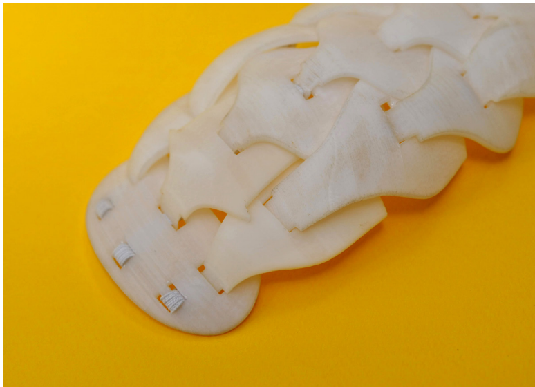
Figura 199. Prototipo focalizado, construido con la tecnología FDM, a través de la impresora Zortrax M-200 y con el material polimérico ZABS plus. Fotografías de David A. Torreblanca-Díaz.
