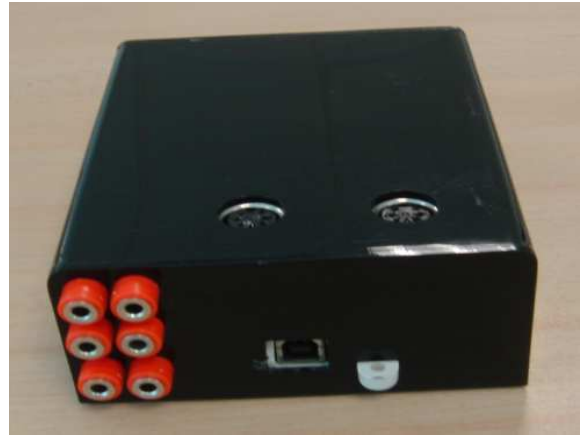
Figura 1.15 Módulo portátil de adquisición de señales electromiográficas.
