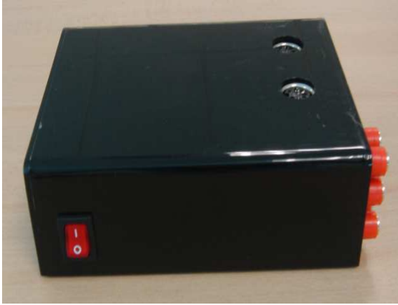
Figura 1.15 Módulo portátil de adquisición de señales electromiográficas.
