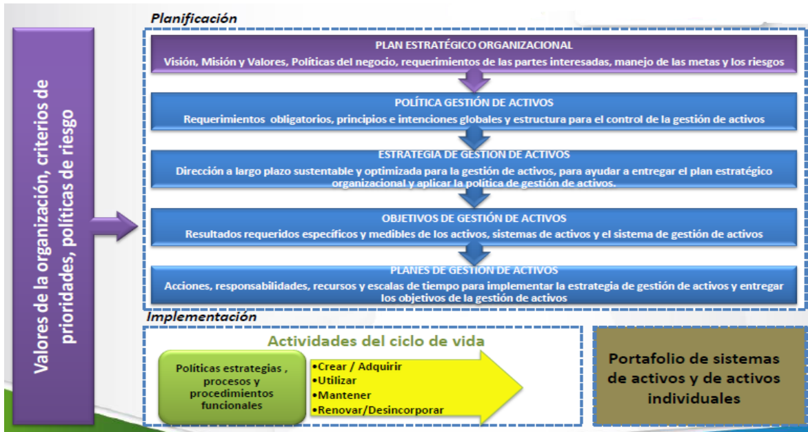
Figura 10. Visión general de un sistema de gestión de activos (SGA). Fuente: FICEM
