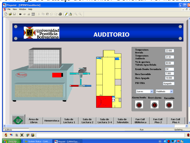
Ilustración 51. Plataforma de control del auditorio.
