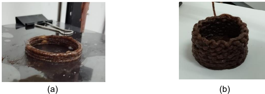
Figura 3. Evidencias de impresiones 3D realizadas con la impresora Creality con la formulación correspondientes para la muestra 1 probando la impresión de cilindros, y (b) Muestra 1 con una geometría estructuralmente más compleja
