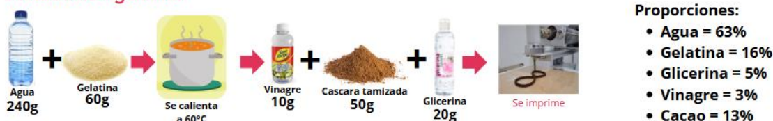
Figura 1. Procesamiento de la cascara de cacao y la formulación del biomaterial. Autoría propia.
