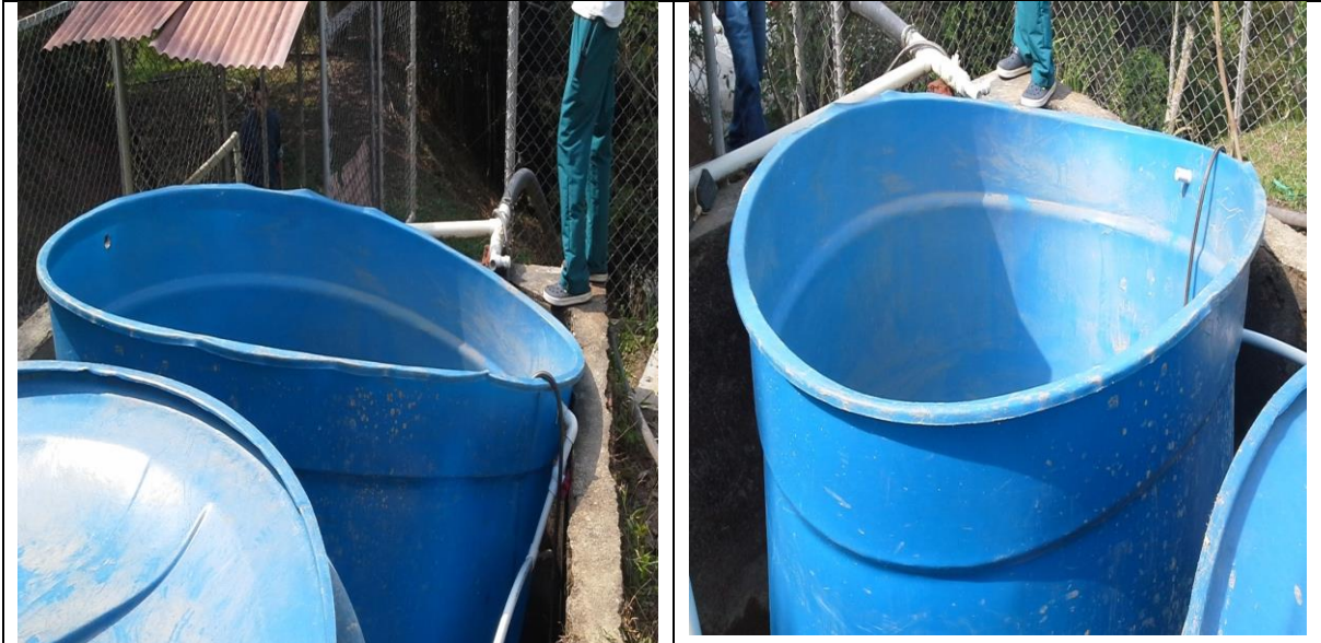
Daño tanque de agua por defecto de fábrica.
