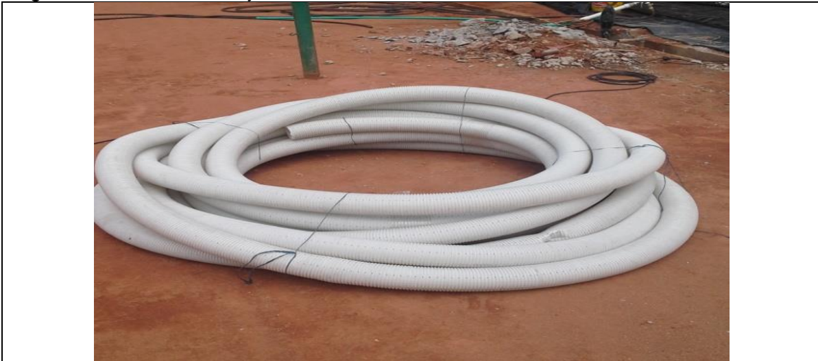
Tubería de apoyo para drenaje lateral
