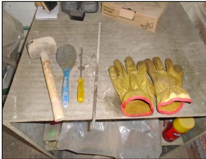
Imagen 6. elementos utilizados para la elaboración de cilindros de mortero.
