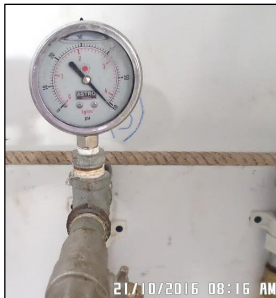
Imagen 30. segunda prueba de hermeticidad, toma 2 (local 3).
