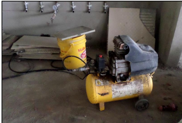
Imagen 24. Compresor utilizado para la prueba de hermeticidad.
