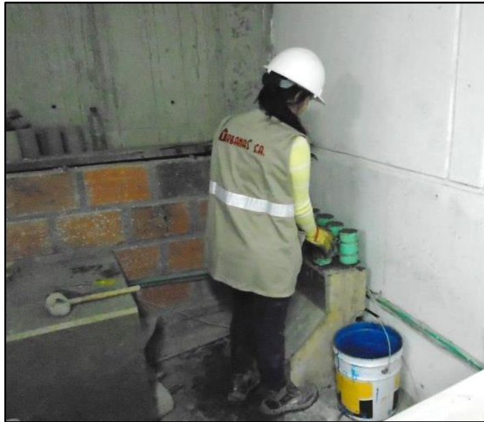
Imagen 7. Elaboración de cilindros.
