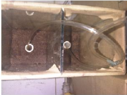
Figura 9. Entrada del caudal de oxígeno a los reactores
