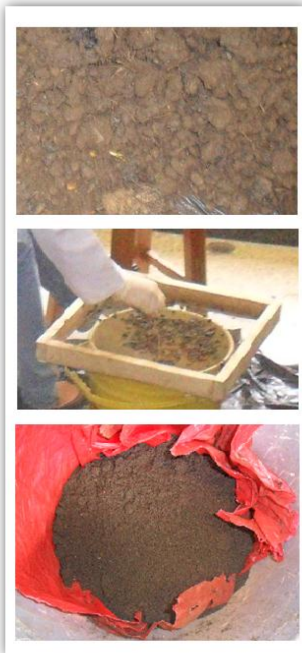
Figura 5. Homogenización de la muestra de suelo contaminada con hidrocarburo
