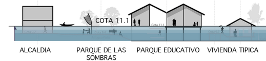
▶ ESQUEMA SISTEMA PALAFÍTICO [ Fuente: Internet + intervención propia ] Composición a partir de sistema palafítico que permite permanecer sobre cota de inundación.
