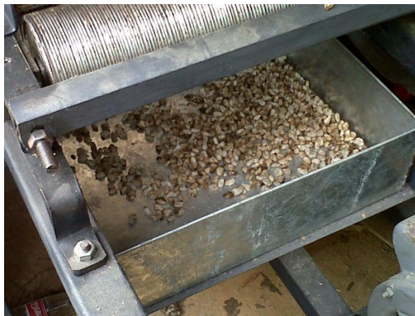
Figura 18. Semillas de algodón después de atravesar los cilindros. Tomada por Juan Pablo Hinestroza Durán.
