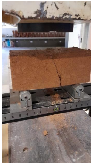
Figura 6.3.2.1 ensayo de resistencia a la flexión de ladrillo virgen
