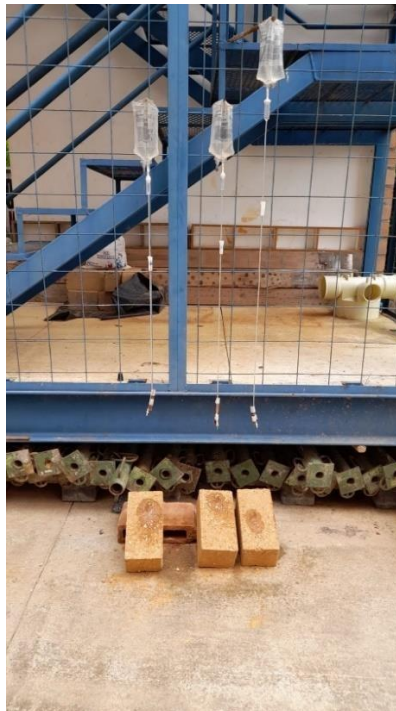
Figura 7.3.3.2 ensayo de resistencia a la erosión de bloques con agregado de polietileno
