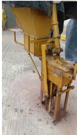
Figura 7.2.2 Maquina empleada para elaborar los bloques de tierra comprimido
