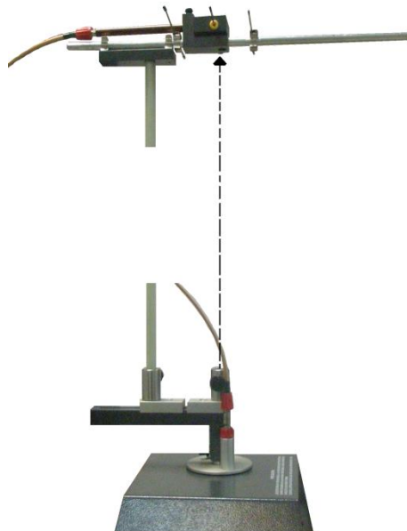
Figura 9.9 Montaje de una Yagi, tres elementos.
