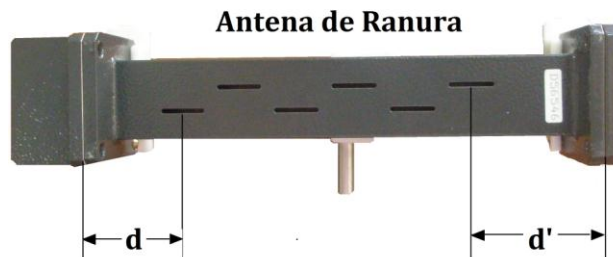
Figura 10.13 Montaje de la placa de cortocircuito y del adaptador de guía de ondas en los extremos opuestos de la antena ranurada.
