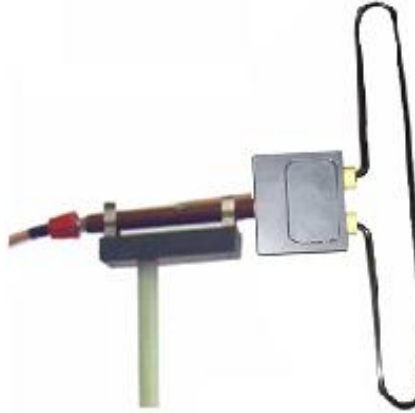
Figura 5.16 Montaje de una antena dipolo plegado sin balún
