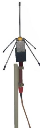
Figura 6.10 Montaje de un monopolo de brazos inclinados.
