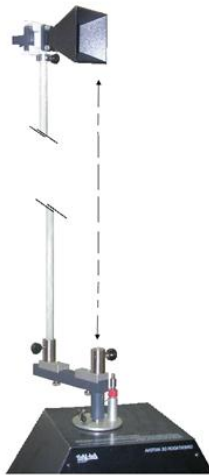
Figura 8.12 Montaje de la antena receptora
