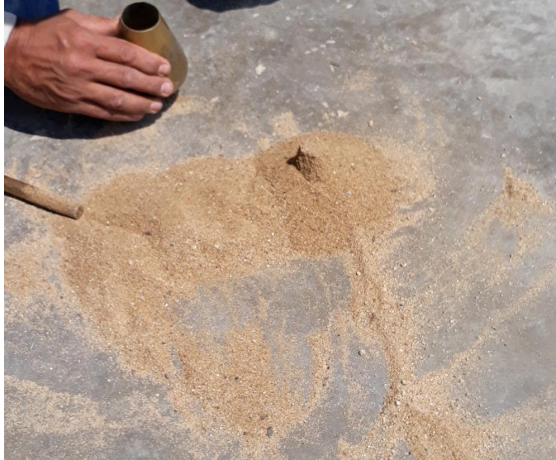
Figura 5. Ensayo de cono de arena.
