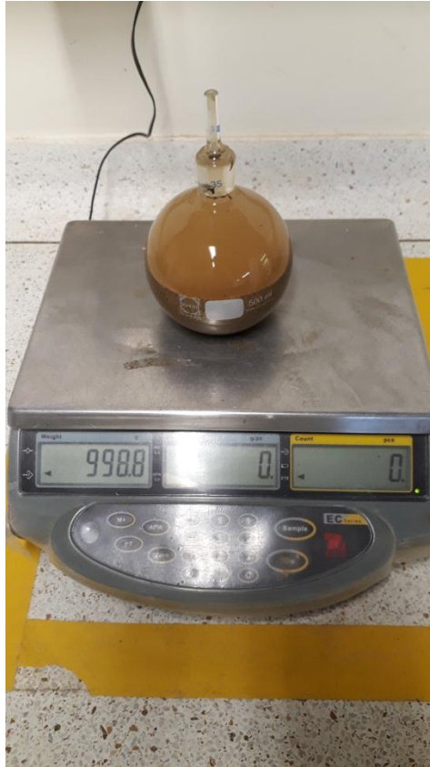
Figura 6. Masa del picnómetro con el agua y los 500 g de agregado fino en estado saturada y superficialmente seca.
