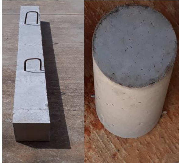
Figura 10. Desencofrado de viga de concreto reforzado y su testigo
