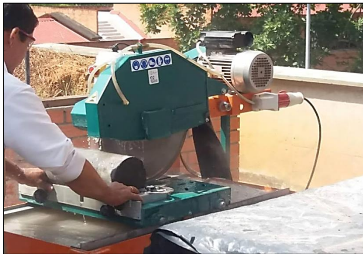
Ilustración 25. Corte de cilindros, para obtener muestras.
