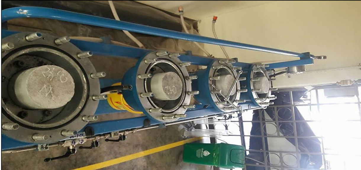
Ilustración 34. Montaje las muestras para realizar el ensayo de permeabilidad.
