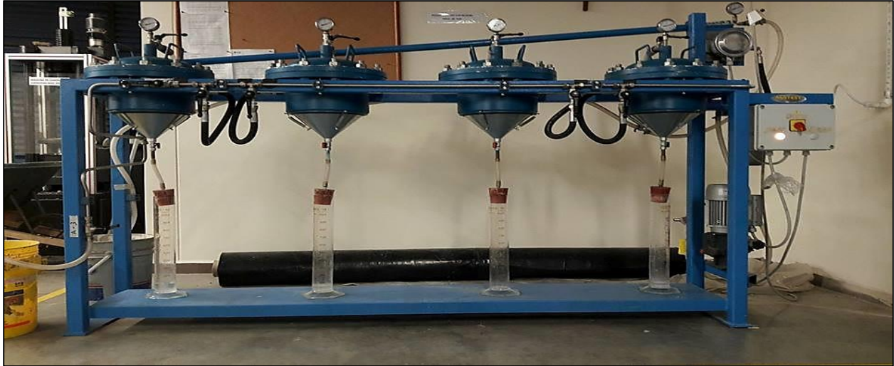
Ilustración 35. Equipo para hallar la conductividad hidráulica.
