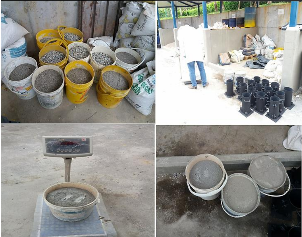
Ilustración 13. Cuantificación de los materiales para la fundición del concreto.
