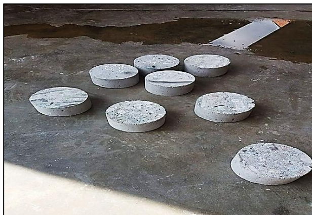
Ilustración 26. Muestras de concreto para el ensayo del ion cloruro.
