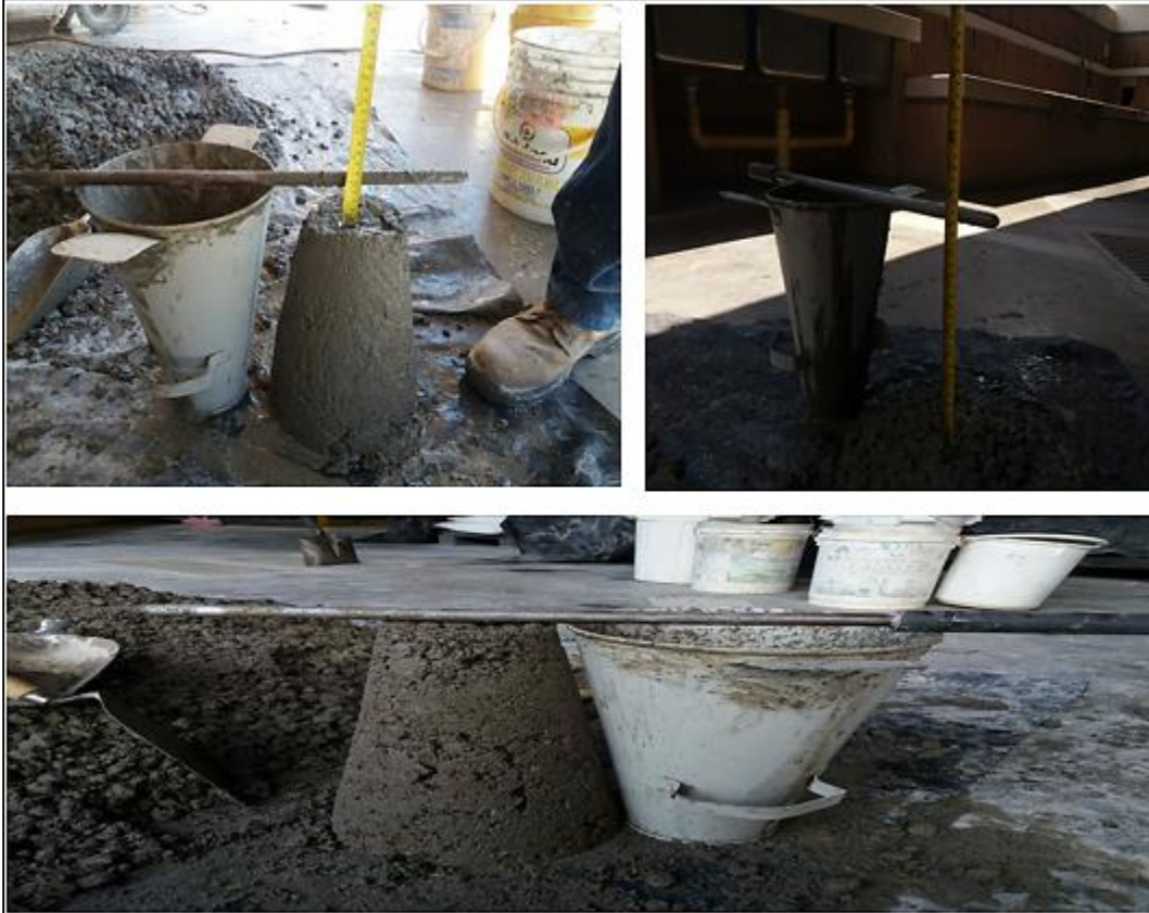
Ilustración 17. Medición de la consistencia con el cono de Abrams para la tres relaciones agua/cemento 0,52, 0,62 Y 0,42.
