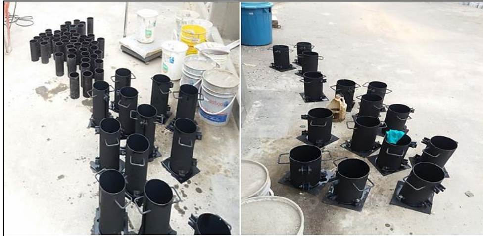
Ilustración 14. Formaletas preparadas para el vaciado del concreto.
