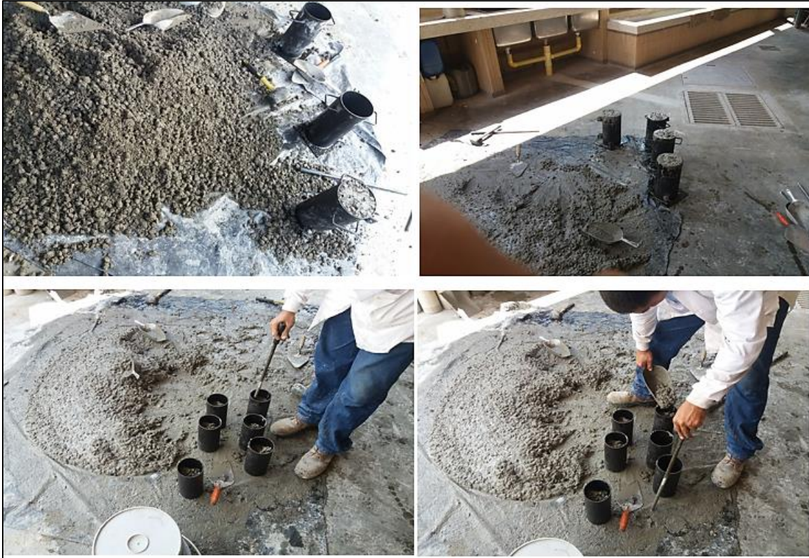
Ilustración 18. Vertimiento de la mezcla de concreto en las formaletas cilíndricas.
