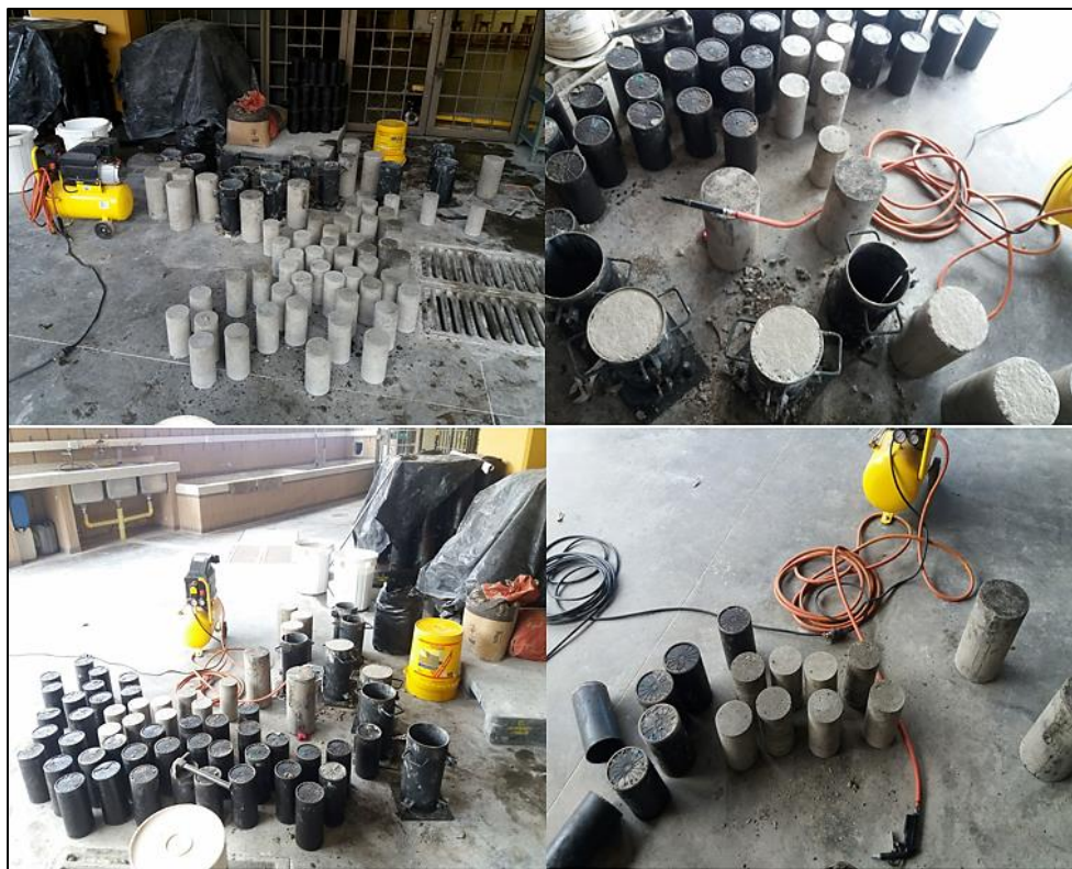
Ilustración 20. Desencofrado de formaletas.
