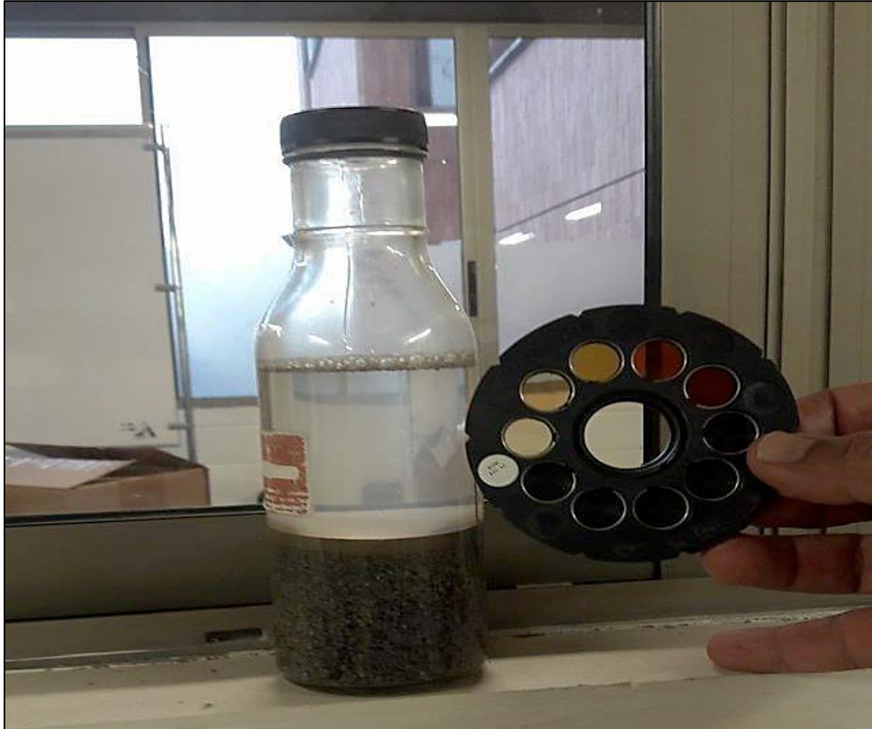
Ilustración 5. Ensayo de materia orgánica del agregado fino.
