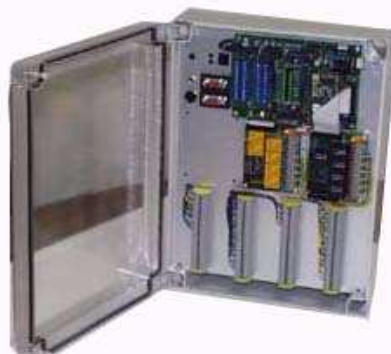
Figura 14. Unidad Terminal Remota
