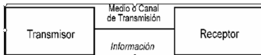
Figura 17. Esquema de un sistema de Comunicaciones
