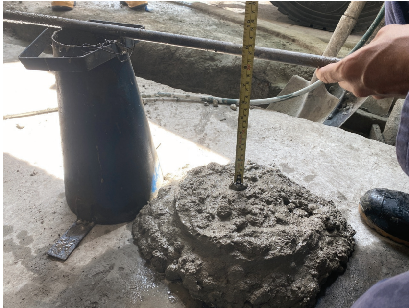
Figura 17. Ensayo de cono
