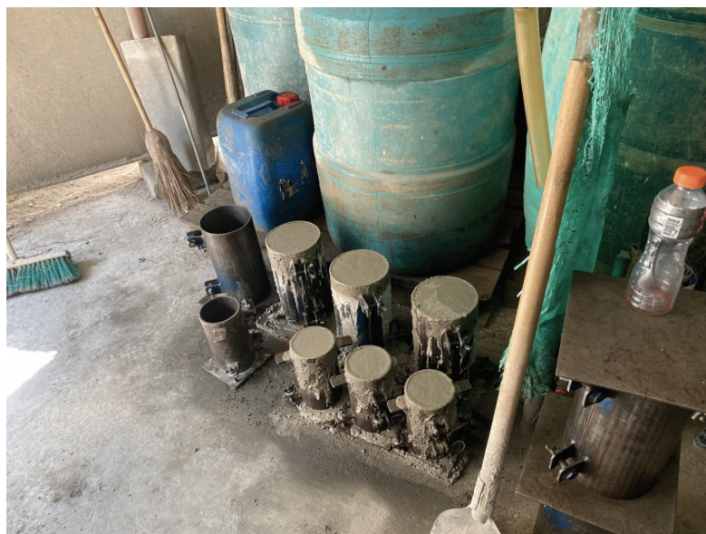
Figura 16. Toma de muestras cilíndricas para ser enviadas al laboratorio
