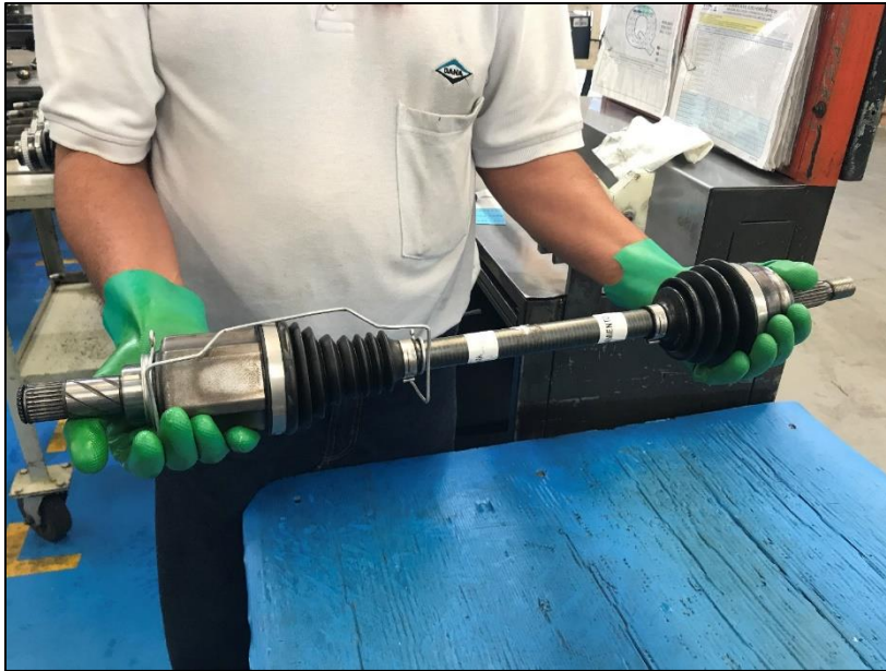
Ilustración 44, Manipulación adecuada para el eje homocinético con férula acondicionada
