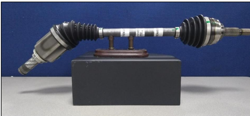
Ilustración 42, Eje bloqueado debido a la mala manipulación
