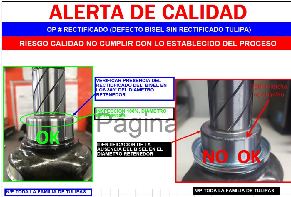
Ilustración 24, Fragmento de imagen, alerta de calidad por rectificado de bisel, Línea de tulipas
