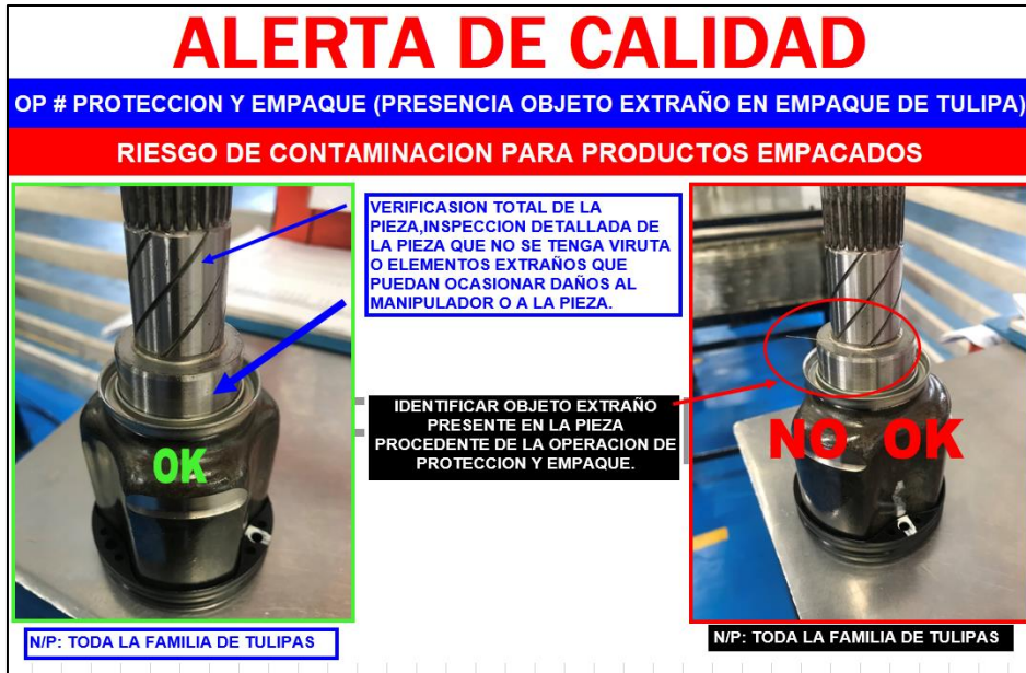
Ilustración 25, Fragmento de imagen, alerta de calidad por presencia de fibra en el empaque de tulipa, Línea de almacén
