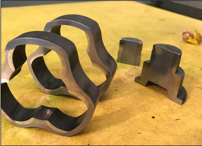
Ilustración 34, Fotografías segmentos de tulipa listos para medición metalográfico
