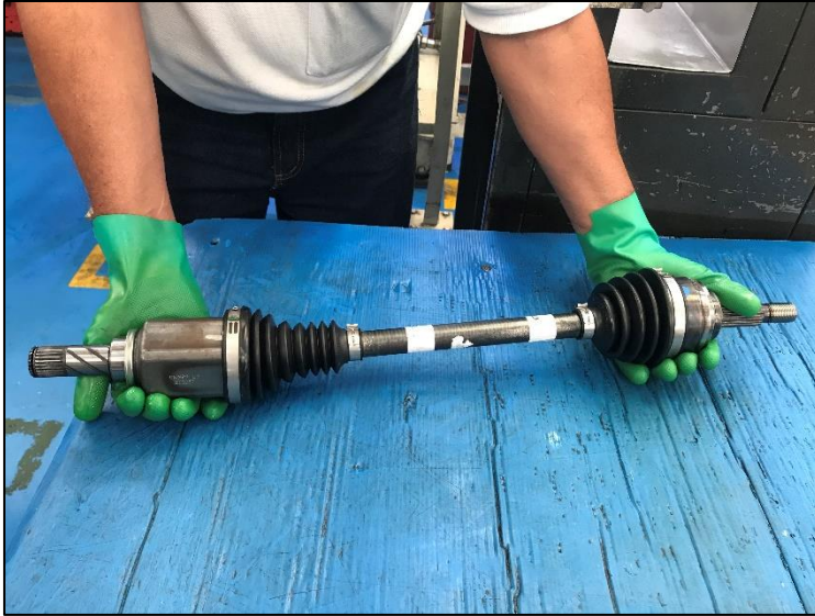
Ilustración 38, Forma correcta de tomar el eje homocinético desde la mesa
