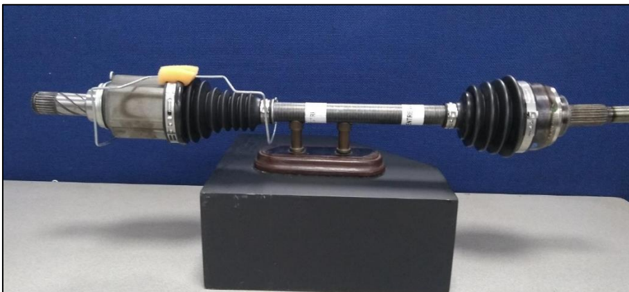
Ilustración 43, Eje con férula acondicionada
