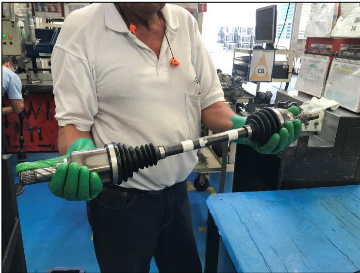
Ilustración 39, Forma correcta de transportar el eje
