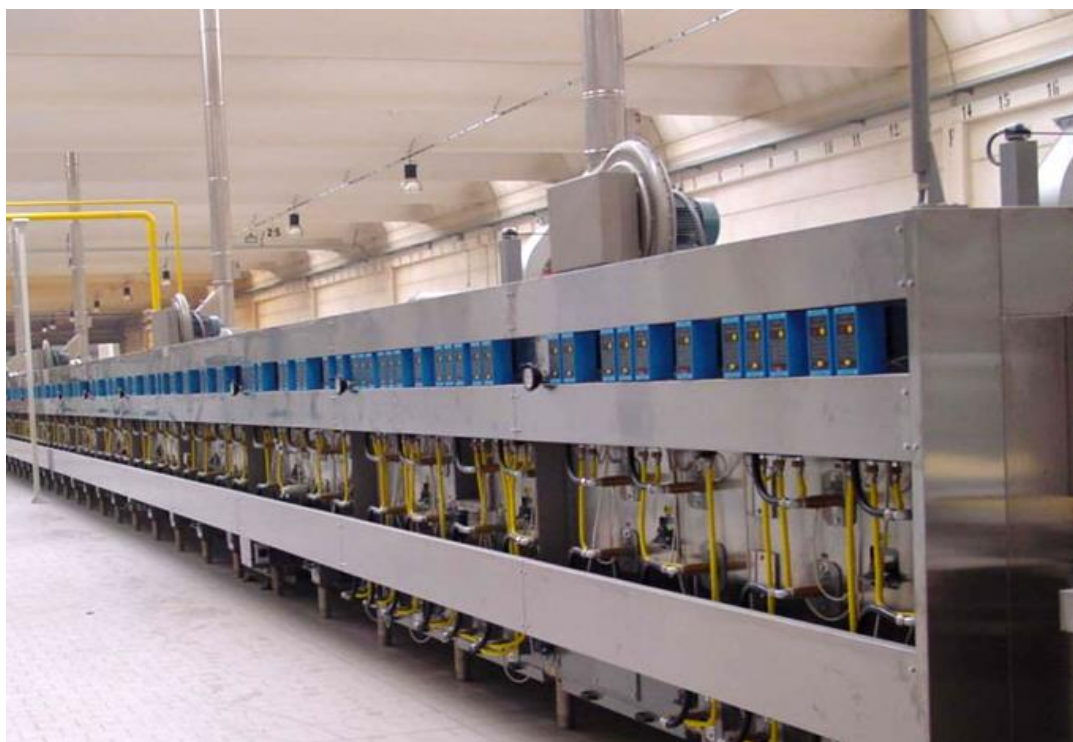
Figura 4 Horno Industrial a Fuego Directo para galletas tipo Crackers ( IMAFORNI INT'L S.p.A )
