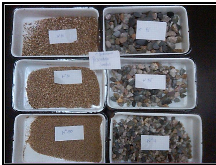
Figura 12. Secado de las muestras, posteriormente a la inmersión
