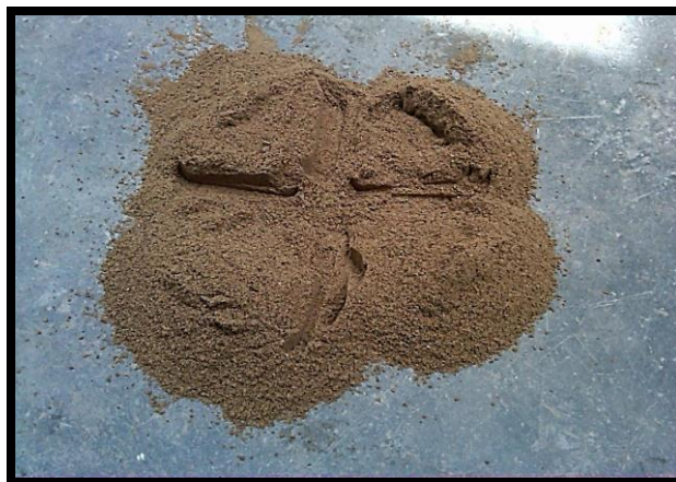
Figura 9. Cuarteo de la muestra
