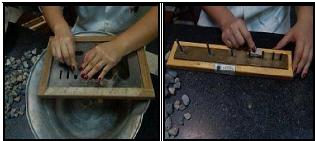
Figura 13. Muestra por las mallas de Aplanamiento y Alargamiento respectivamente
