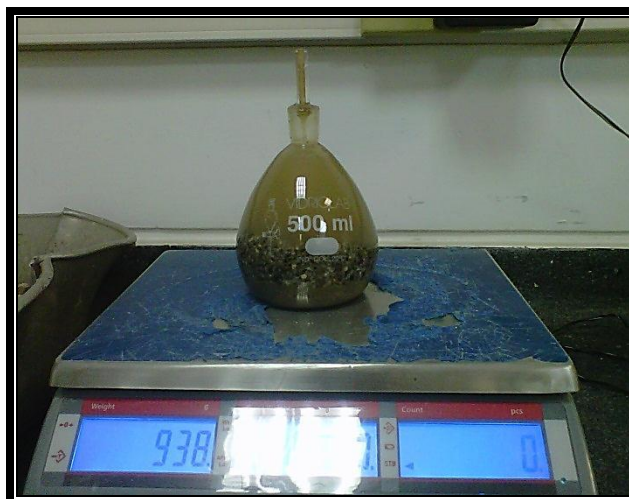
Figura 20. Muestra en el frasco aforado con agua
