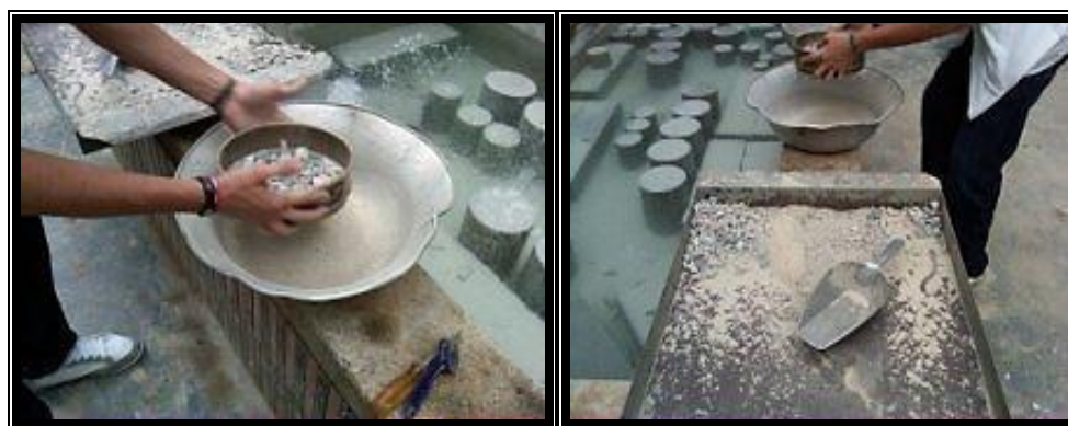
Figura 22. Se tamiza y se lava la muestra después de La máquina de los Ángeles
