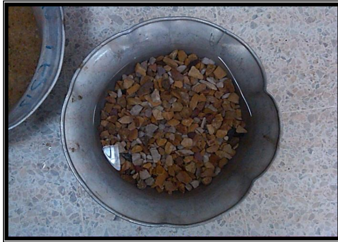
Figura 15. Muestra del agregado Grueso sumergida en Agua durante 15 horas.
