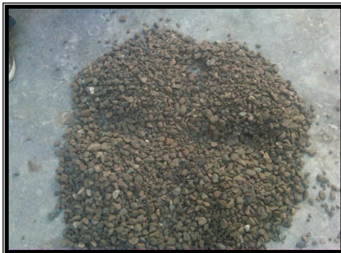
Figura 14. Cuarteo de la muestra de agregado grueso
