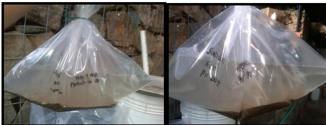
Figura 11. Muestra en proceso de inmersión (solución de sulfato de sodio)
