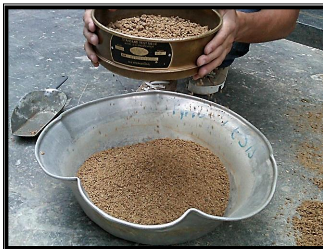
Figura 17. Muestra que pasa el tamiz N° 4 para realizar el ensayo
