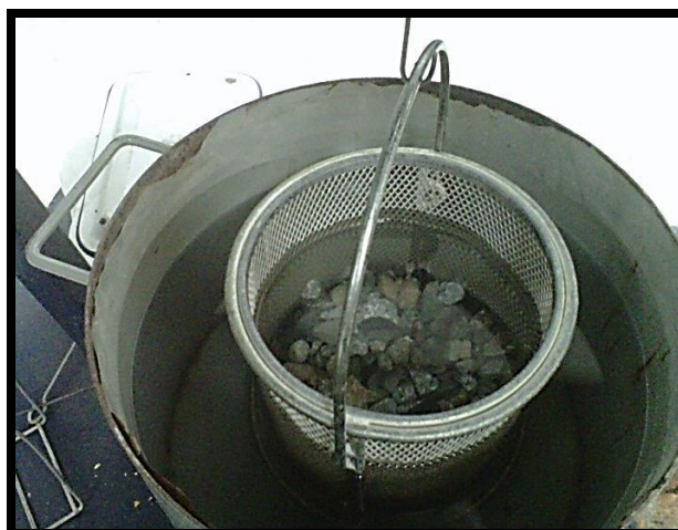
Figura 16. Muestra del agregado grueso sumergida dentro de la canastilla
