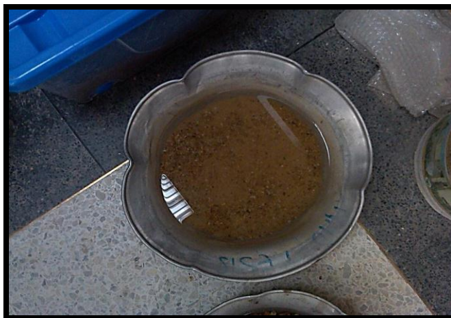
Figura 18. Muestra en periodo de inmersión durante 15 horas.
