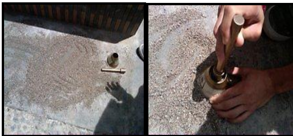
Figura 19. Prueba del cono metálico para medir la absorción
