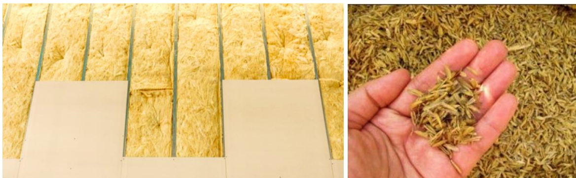
Figura 83. Aislamiento térmicoacústico con fibras naturales. RPP (2018). Cascarilla de arroz. Monge (2016).
