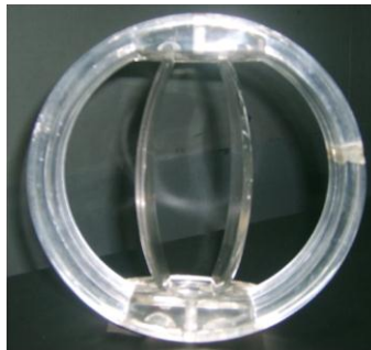
Figura 2. Modelo con valvas modificadas, escala 1:7. Figura tomada de (Bustamante, Crispin, Escobar, & Giraldo, Análisis in vitro de la influencia sobre el campo de flujo de dos modelos de válvulas cardíacas mecánicas bivalvas mediante un túnel de viento, 2011)
