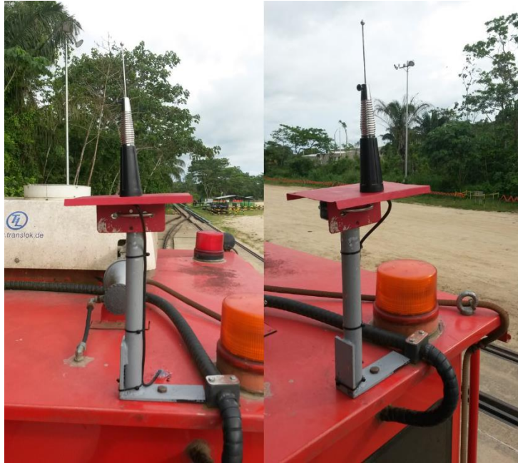
Figura 40: Antena omnidireccional instalada en la locomotora Translok.
