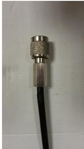
Figura 37: Conector TNC unido al cable RG58.
