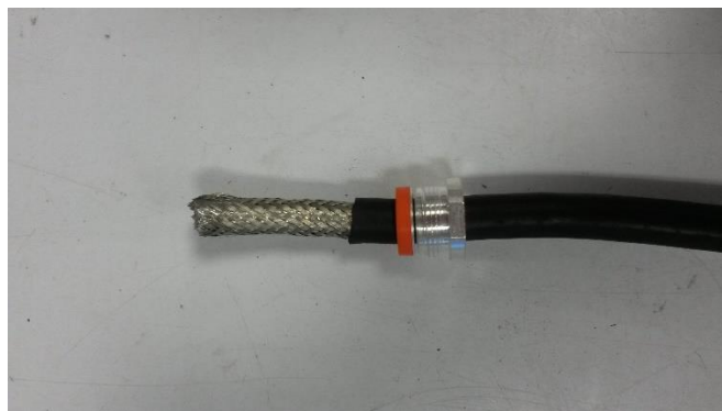
Figura 28: Vista lateral del cable RG8 con conductor externo trenzado.
