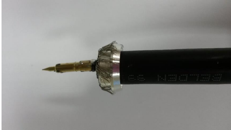
Figura 31: Vista lateral del cable RG8 con el pin.
