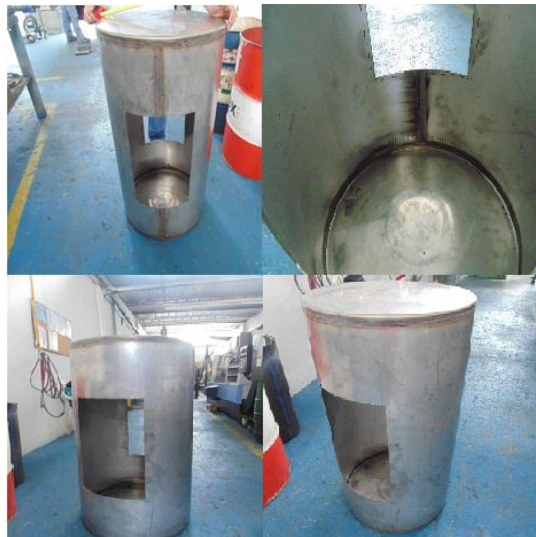
FIGURA 2-1: CONSTRUCCIÓN DE LOS TANQUES DE ALMACENAMIENTO POR LA EMPRESA ING&MAQUINAS
