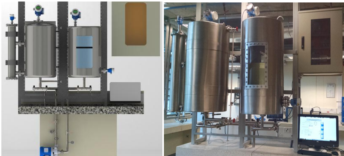
FIGURA 1-1. DISEÑO CAD DEL MÓDULO VS IMPLEMENTACIÓN [1]
