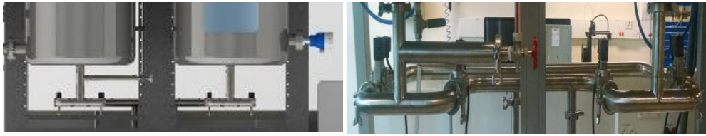
FIGURA 1-3. DISEÑO CAD DE LAS ELECTROVÁLVULAS Vs IMPLEMENTACIÓN [1]
