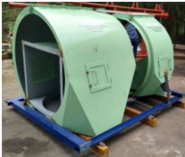
Figura 116. Tolvas y chute de carga.
