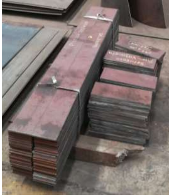
Figura 122. Refuerzos del fondo de la vagoneta.
