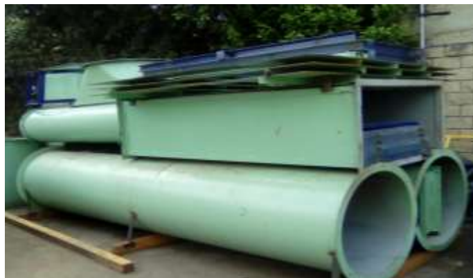
Figura 92. Ductos silo de secado de almendra y nuez.
