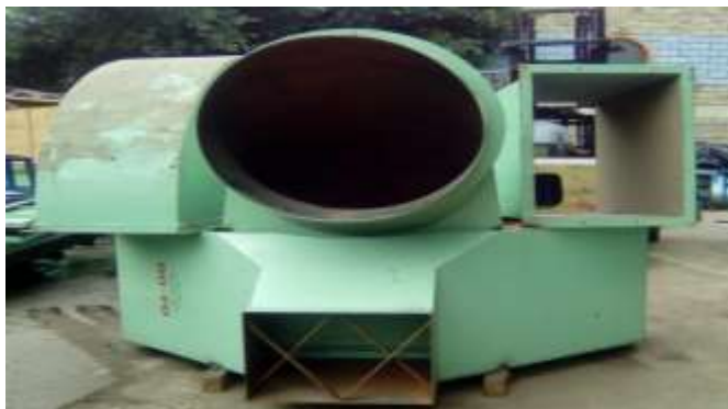
Figura 98. Tolva descargue tambor desfrutador + 2 ductos intermedios silo de almendras + chute de cargue tambor desfrutador + codo C ducto silo de nuez.
