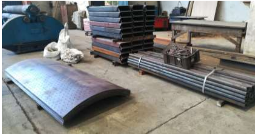
Figura 124. Laminas frontales, perfil del fondo, cartelas y rebordes de la vagoneta.
