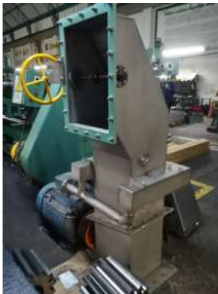
Figura 121. Ducto inoxidable fabricado en G1.
