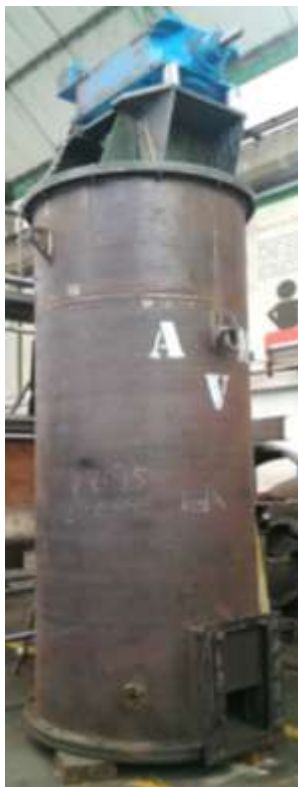
Figura 120. Digestor fabricado en G1.
