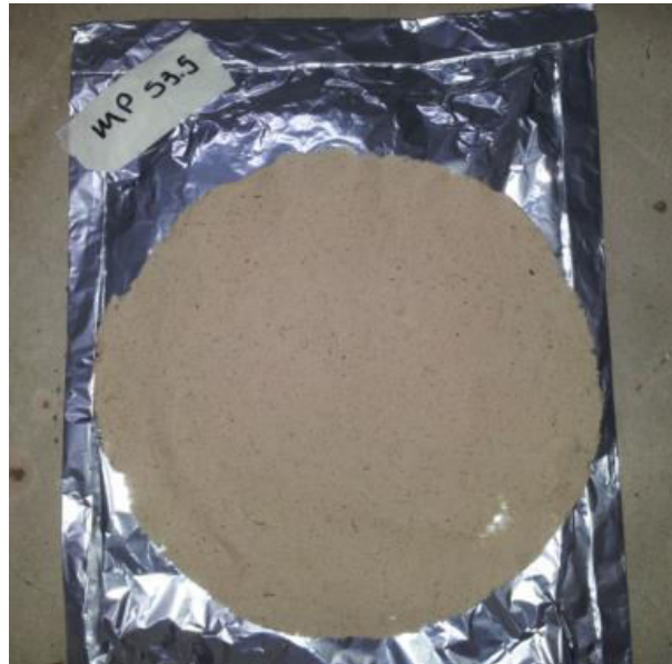
Figura 24: Hoja formada a partir de pulpa de bagazo integral pretratado a severidad 3.5
