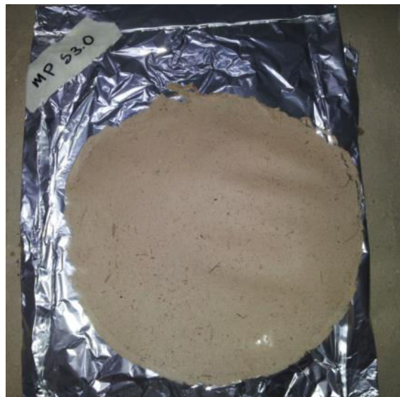
Figura 23: Hoja formada a partir de pulpa de bagazo integral pretratado a severidad 3.0
