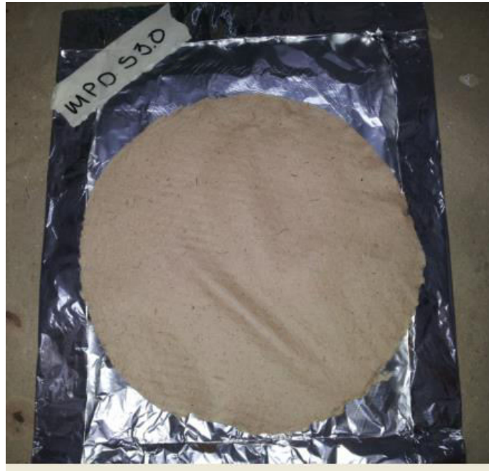
Figura 26: Hoja formada a partir de pulpa de bagazo desmedulado pretratado a severidad 3.0
