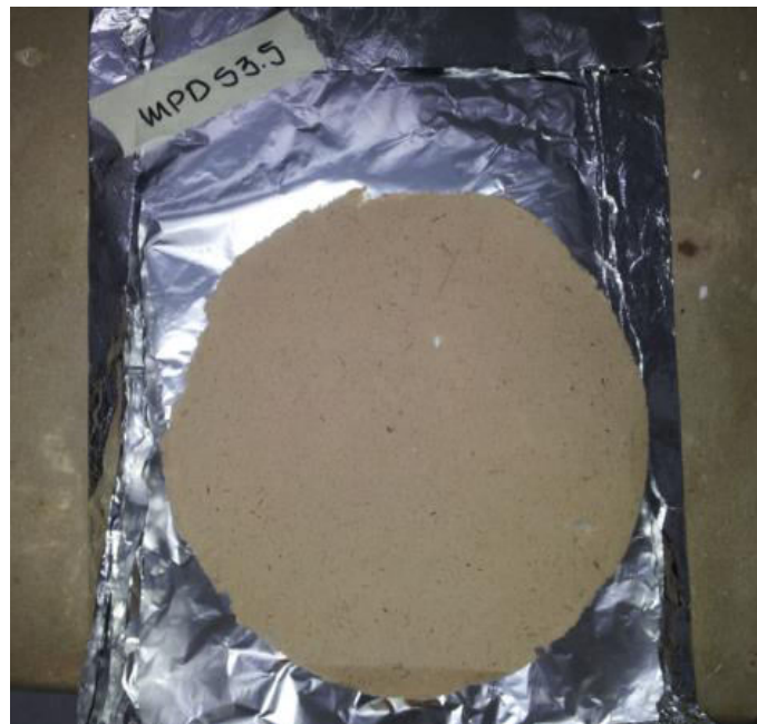
Figura 27: Hoja formada a partir de pulpa de bagazo desmedulado pretratado a severidad 3.5
