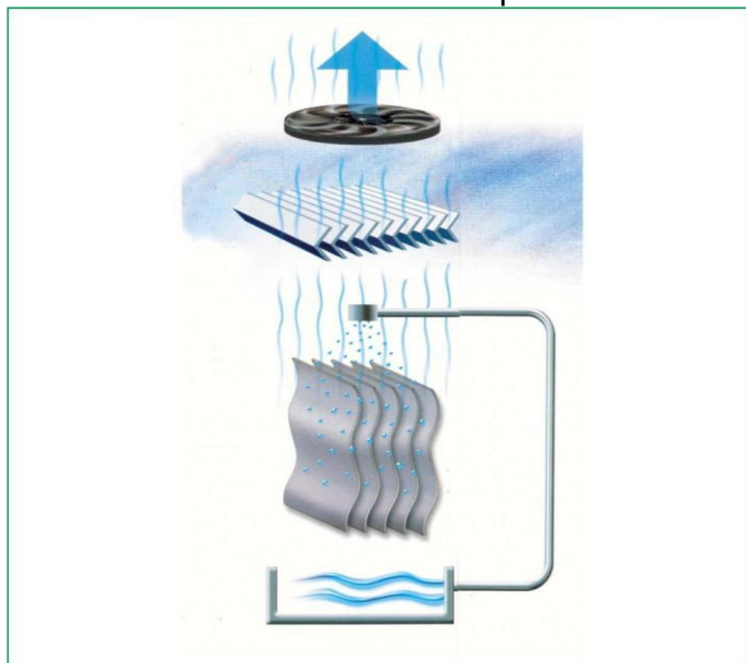
Figura 1. Esquema Básico de un enfriador evaporativo
