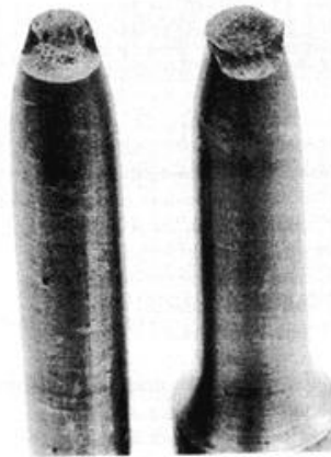
Falla de un material dúctil. (b)
