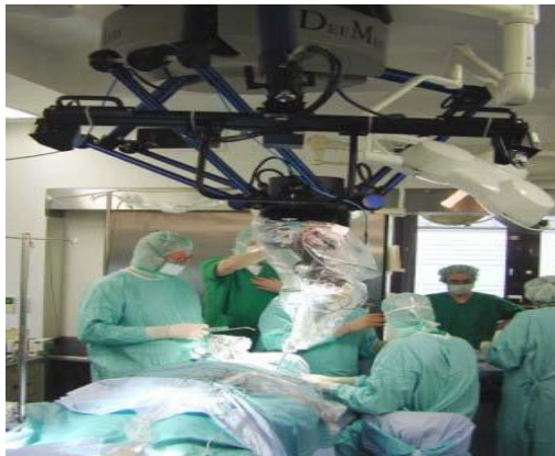
Figura 2.9 El robot Delta en aplicaciones quirúrgicas (Ángel, 2005).
