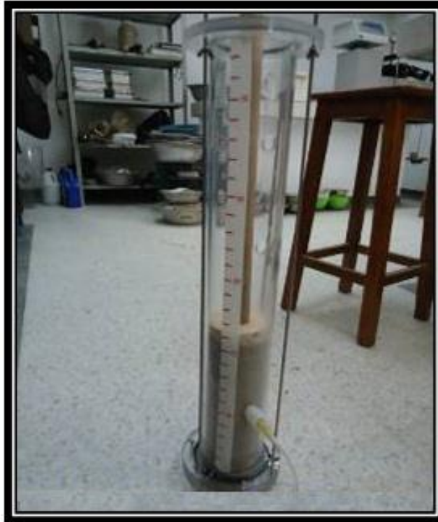
Figura 17 Compactación del material arenoso en capas 2cms, con pisón de madera.
