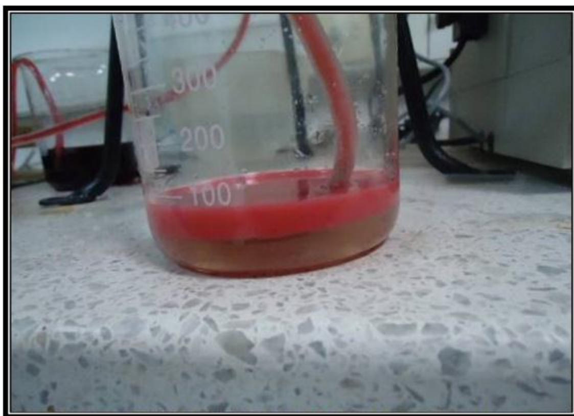
Figura 34 Recolección Contaminante en la salida de la columna de advección.
