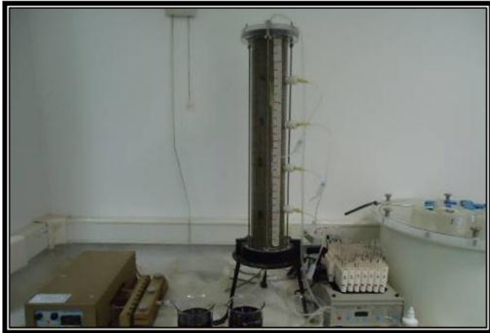
Figura 19 Columna compactada, con sus muestreadores, lista para la saturación con H 2 O, conectada a la bomba de inyección.
