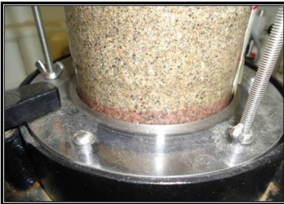
Figura 24 Contaminación primeras capas de suelo en la columna de advección con el Aceite Ref. 15w-40
