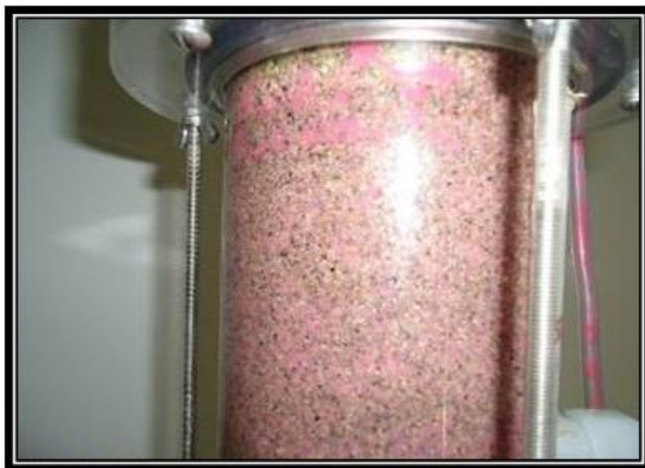
Figura 32 Presencia del contaminante en toda la columna de advección
