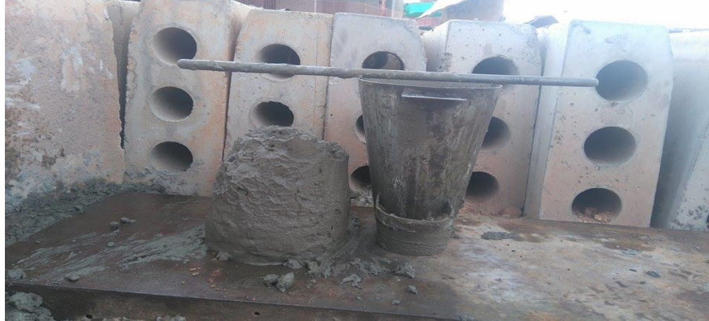
Figura 28 Prueba de asentamiento.
