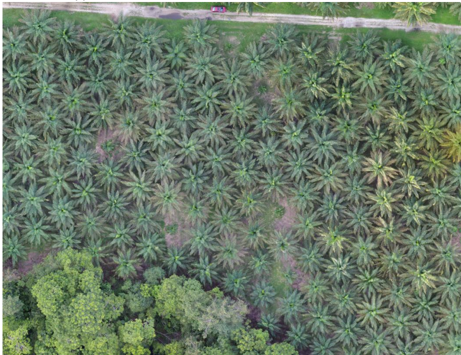
Figura 14. Ortomosaico generado para determinada zona de la plantación mediante el software de fotogrametría Pix4Dmapper
