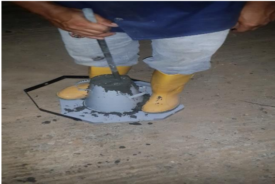
Figura 42. Verificación de asentamiento por medio del slump.
