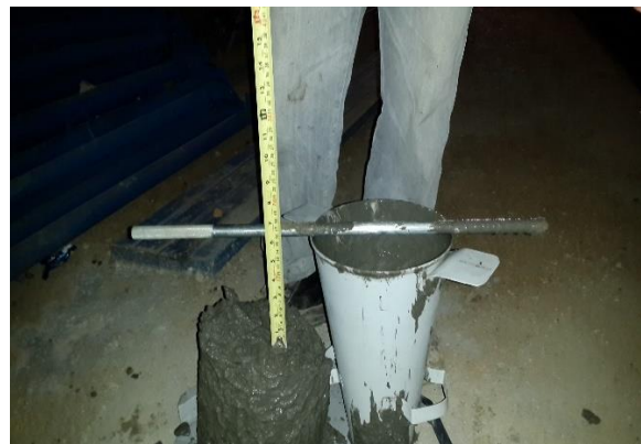
Figura 39. Verificación de asentamiento con el slump y toma de cilindros
