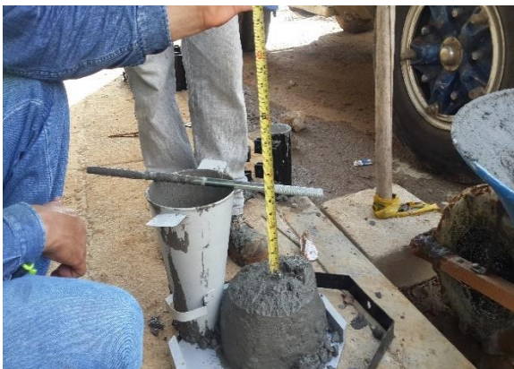
Figura 39. Verificación de asentamiento con el slump y toma de cilindros
