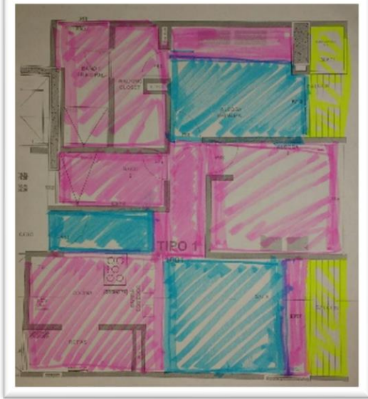
Ilustración 16-Plano de alturas para cielo raso, apto Tipo 1
