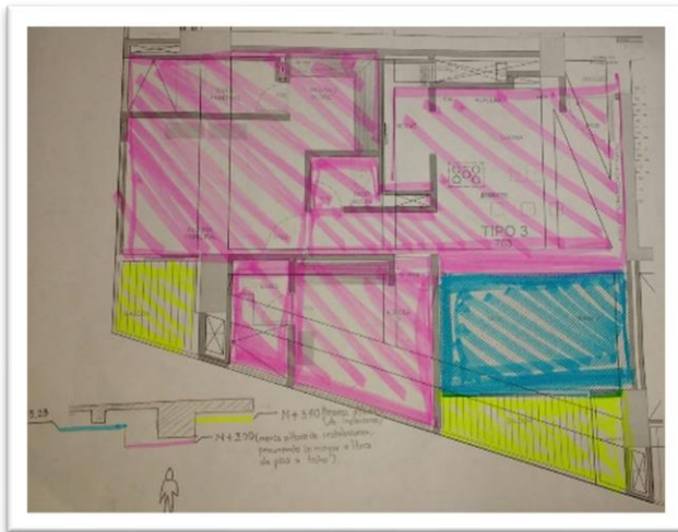
Ilustración 18-Planos de alturas de cielo raso, apto Tipo 3
