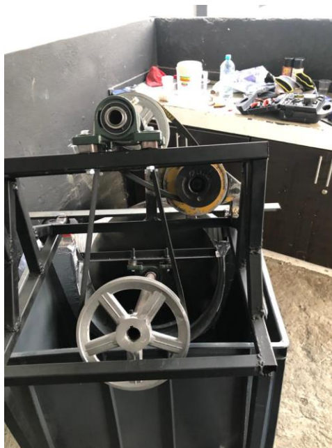
Ilustración 42. Sistema tornillo hidrodinámico terminado.
