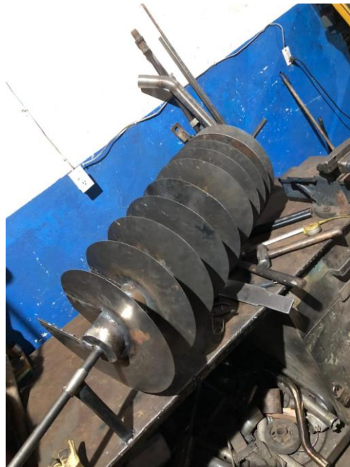
Ilustración 37. Instalación de las aspas del tornillo.
