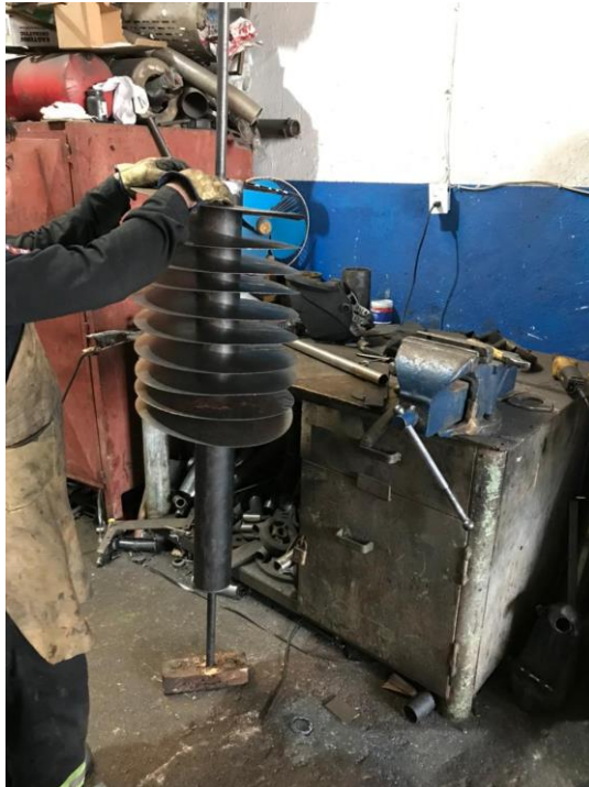
Ilustración 35. Instalación de las aspas del tornillo.
