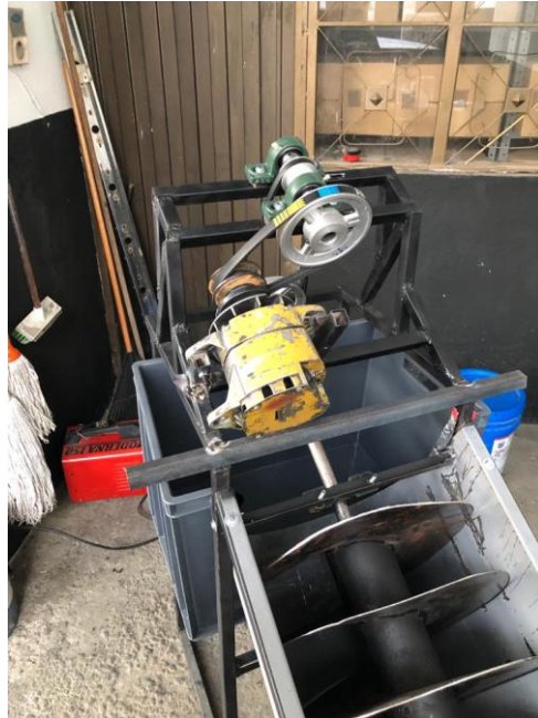
Ilustración 40. Sistema tornillo hidrodinámico terminado.
