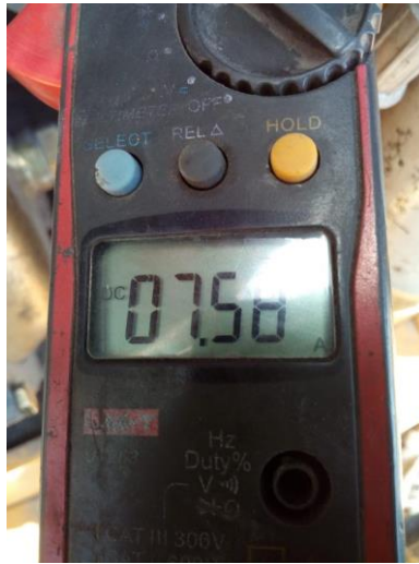
Ilustración 49. Evidencia de los amperios que produce el prototipo.
