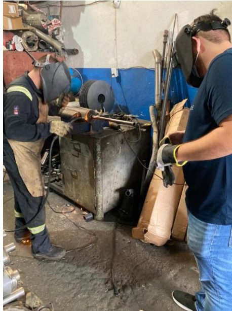
Ilustración 34. Construcción del eje del tornillo.
