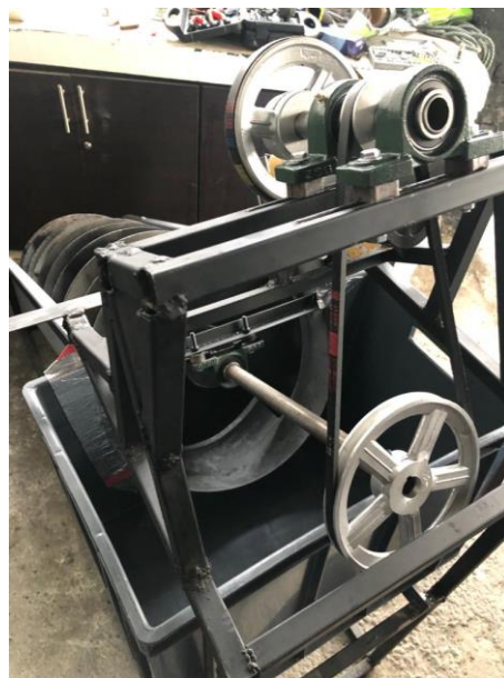
Ilustración 43. Sistema tornillo hidrodinámico terminado.
