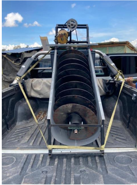
Ilustración 44. Sistema tornillo hidrodinámico terminado.
