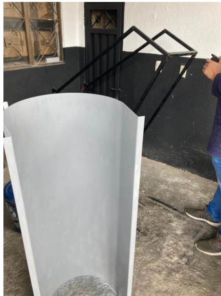
Ilustración 32. Estructura y tolva pintados.
