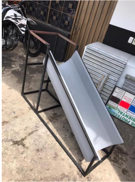
Ilustración 33. Estructura y tolva pintados.
