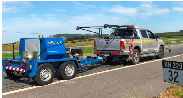
Ilustración 6. Deflectómetro de impacto FWD
