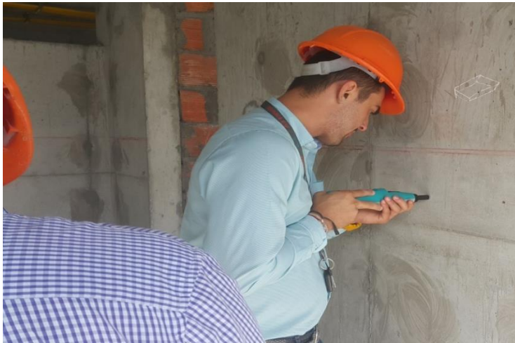
Figura 6. Realización prueba esclerometria.
