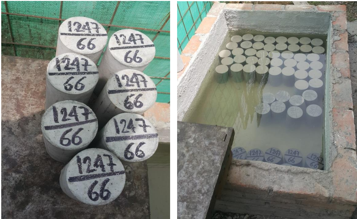
Figura 3. Especímenes codificados – Pileta de curado.
