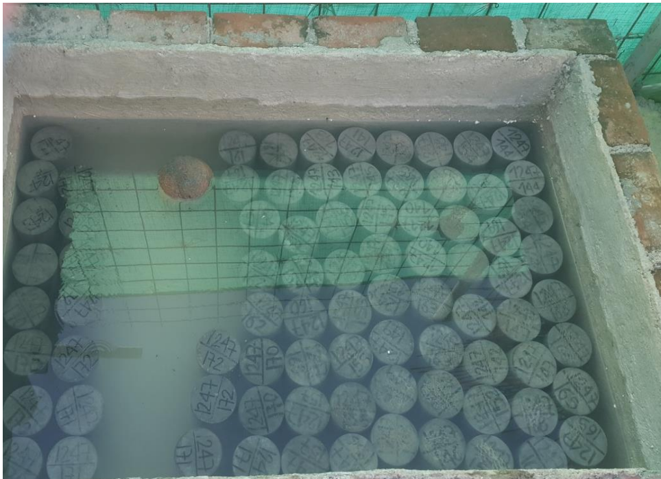
Figura 4. Pileta de curado casi llena.
