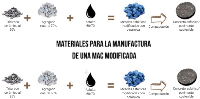
Figura 2. Materiales para la manufactura de MAC modificada.
