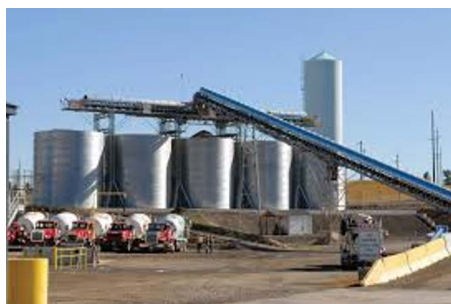
Figura 8. Alternativas de almacenamiento de silos y tolvas 7 .
