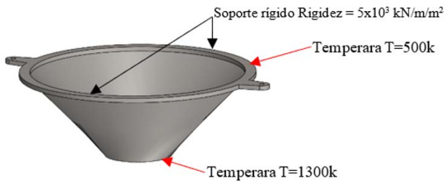
Figura 5. Condiciones operativas del componente crítico del gasificador.
