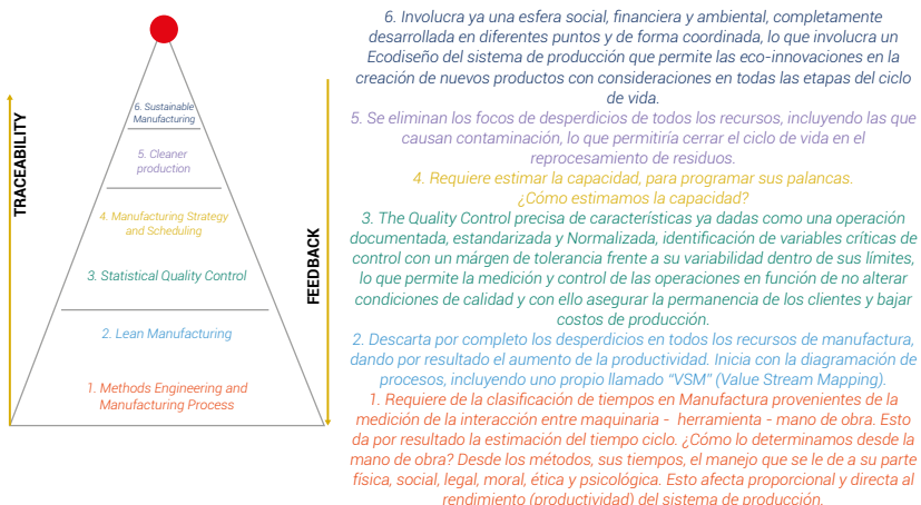
Figura 1. Estructura funcional jerárquica que asegura la trazabilidad de los procesos de producción, mediante el desglose de tareas propuestas por el Lean Manufacturing.
