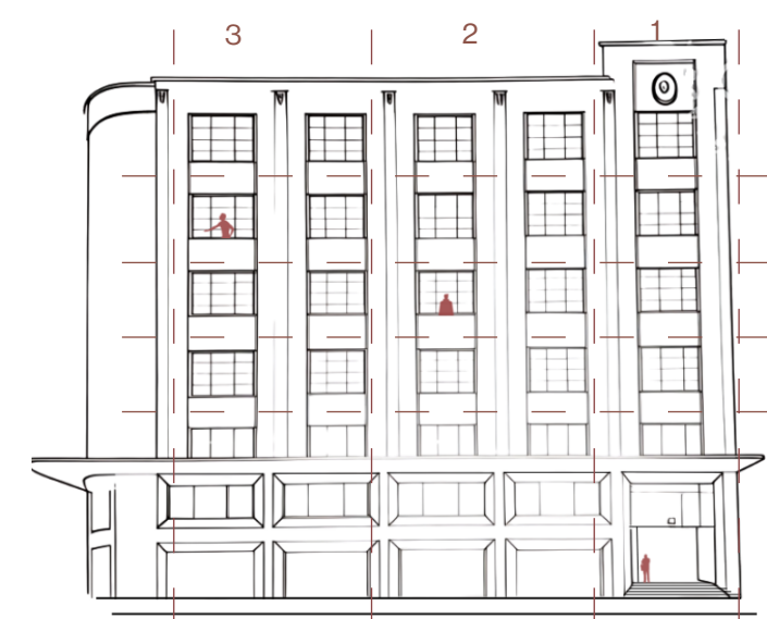
Figura 63. Esquema propio, La antigua compañía Colombiana de Seguros, donde se evidencia la modulación y los ejes de ventanería de la envolvente.
