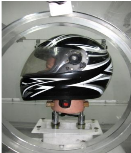
Figura 15. Casco de motocicleta estándar anclado en la sección de pruebas del túnel de viento
