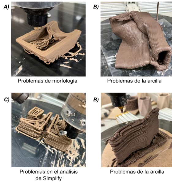
Figura 3. Algunos de los factores de fallo en la impresión 3D en arcilla.
