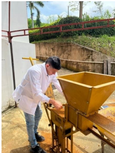
Imagen 20. Prensado en Cinva Ram
