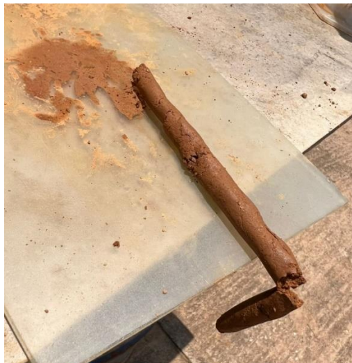
Imagen 14. Test de rollo
