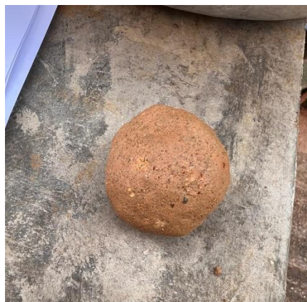
Imagen 6. Test de caiga de bola
