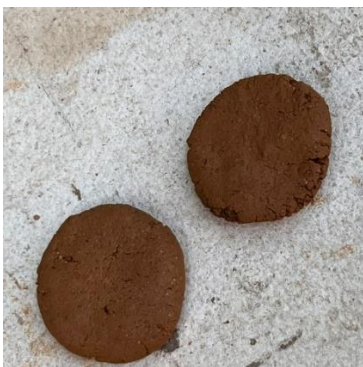
Imagen 11. Test de la resistencia seca inicial
