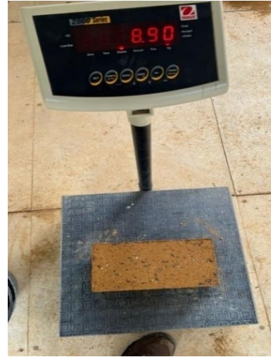
Imagen 35. Fabricación BTC al 6%
