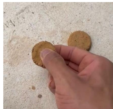
Imagen 13. Test de la resistencia seca final
