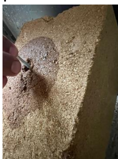
Imagen 49. Erosión BTC Tradicional
