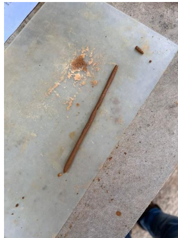
Imagen 9. Fractura en Test de cinta
