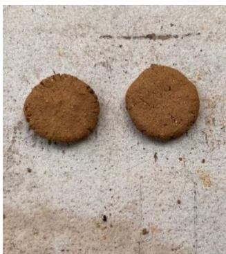
Imagen 12. Test de la resistencia seca media
