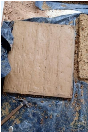
Imagen 24. Fabricación BTC convencional
