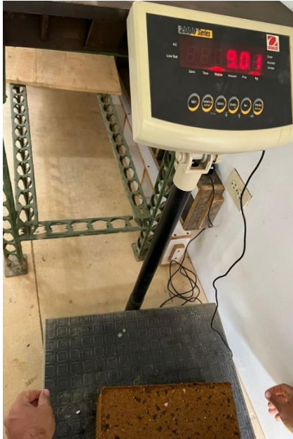
Imagen 37. Fabricación BTC al 8% Imagen 38. Resultado final BTC al 8%
