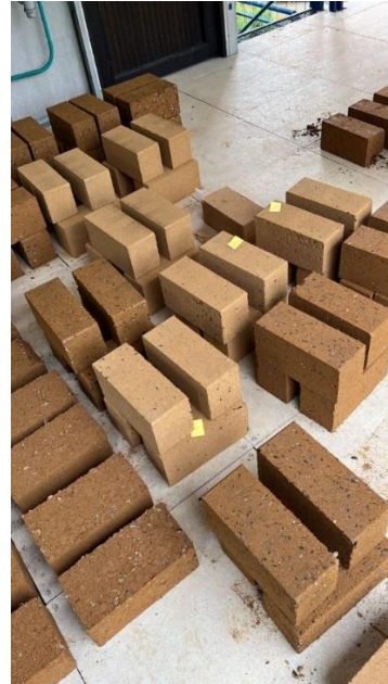
Imagen 37. Fabricación BTC al 8% Imagen 38. Resultado final BTC al 8%
