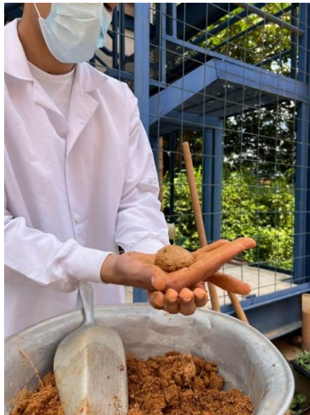
Imagen 10. Test de exudación
