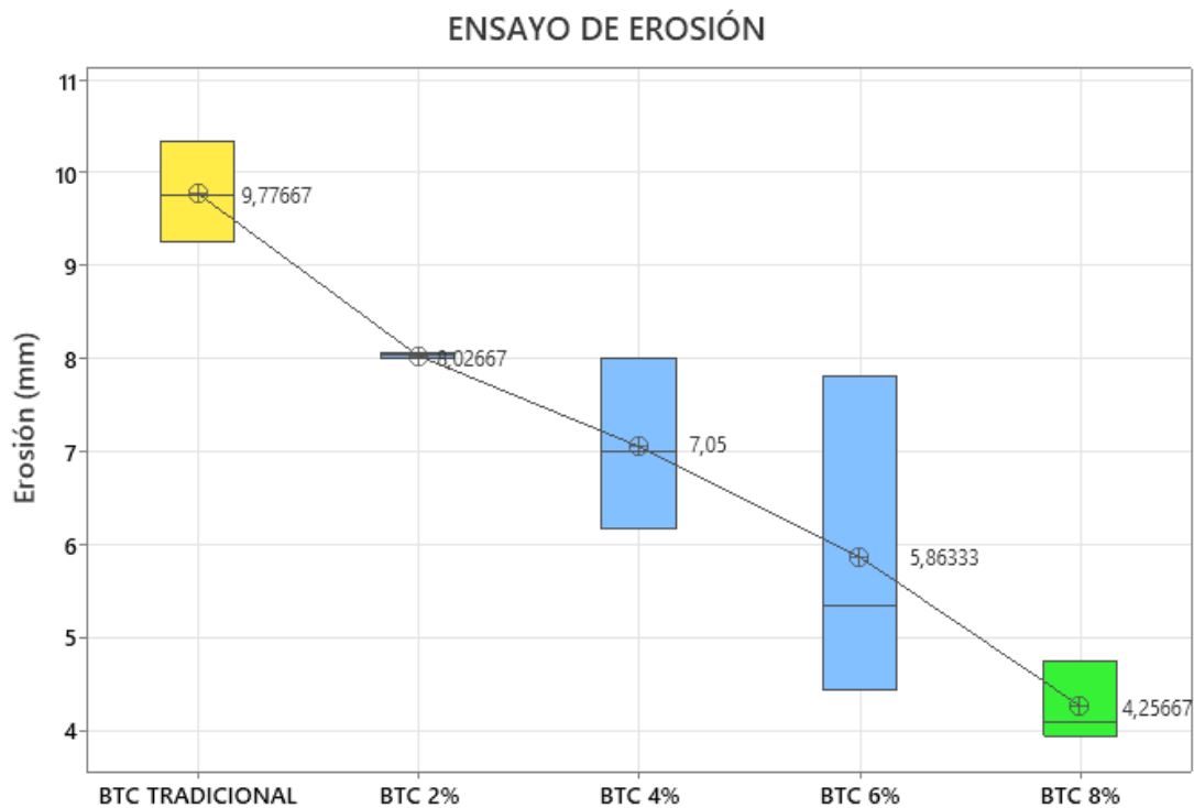
Gráfica 4. Ensayo de resistencia a la erosión
