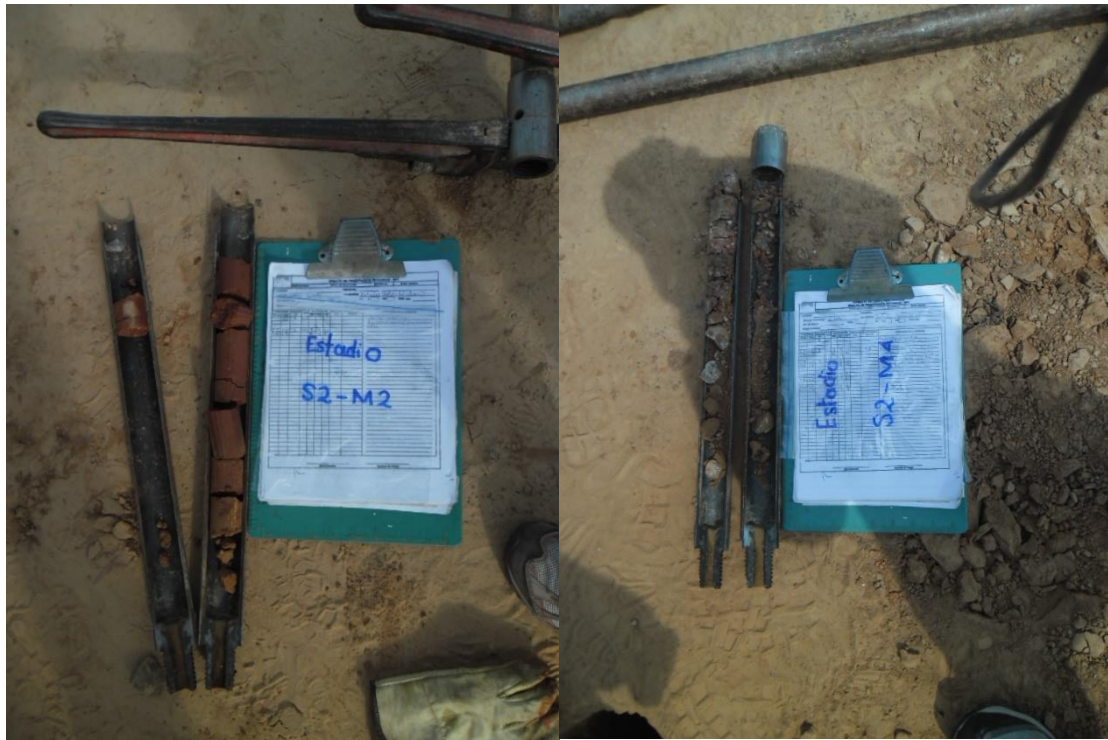
Figura 16. Tomamuestras abierto luego de hacer SPT SONDEO 2
