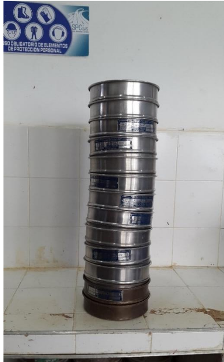
Figura 5. Tamices armados para hacer granulometría
