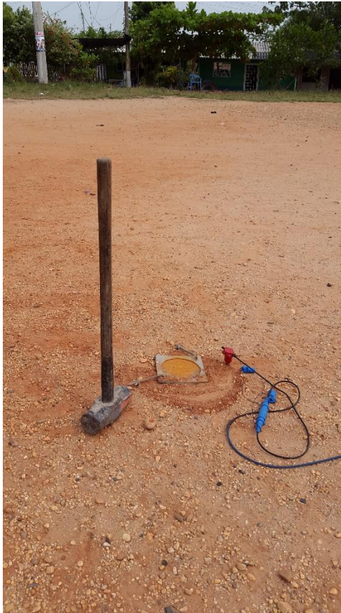
Figura 55. El SHOOT se realiza a partir de un estruendo
