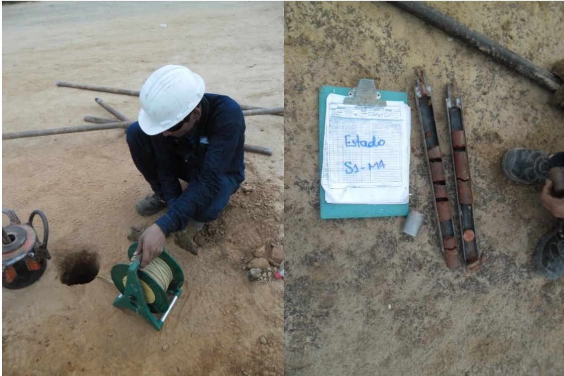
Figura 17. Toma del nivel freático (Izquierda). Toma muestras SONDEO 1 (Derecha)
