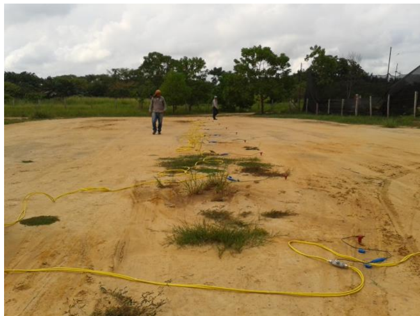
Figura 50. Línea principal con sus respectivos geófonos
