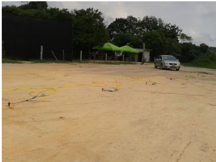
Figura 46. Conexión entre los geófonos (Color rojo) y la línea principal
