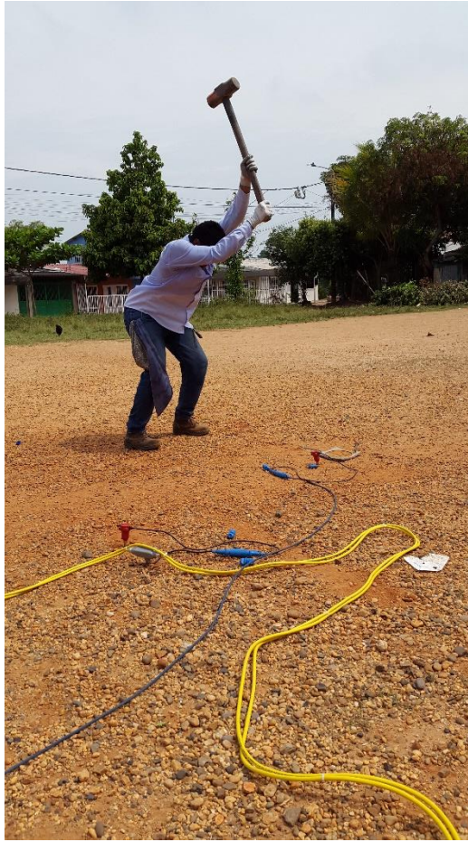
Figura 57. El ayudante genera un golpe para la generación de las ondas
