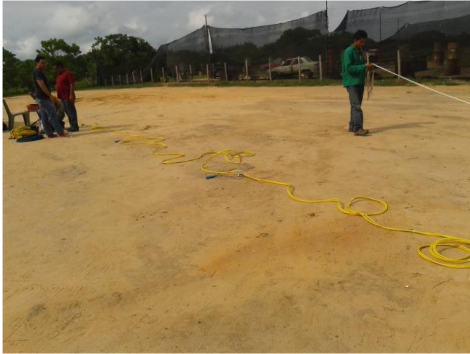
Figura 45. Tendido de línea de refracción sísmica: ajuste de medidas
