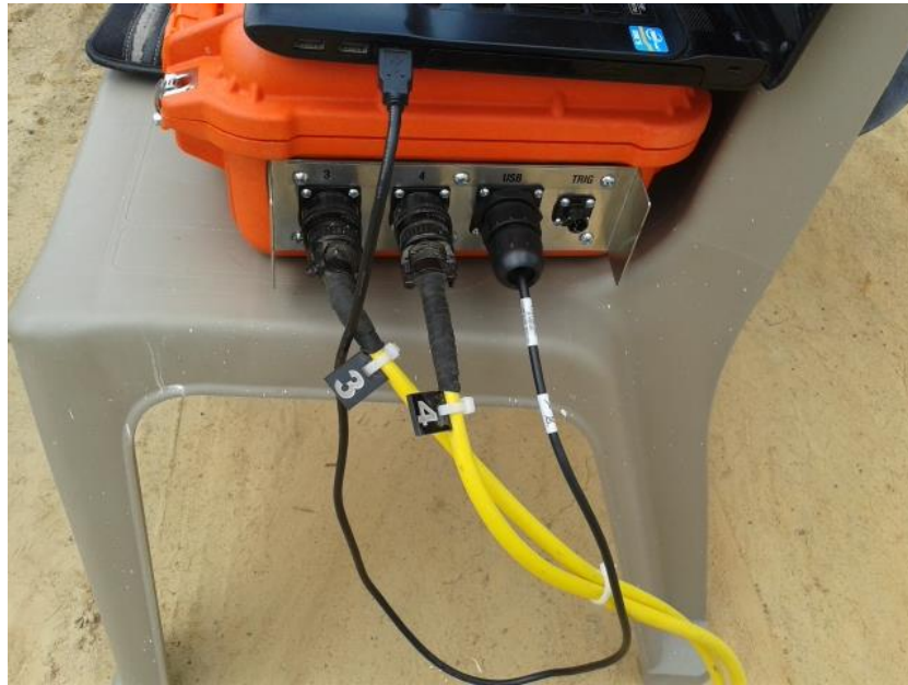
Figura 49. Conexión del software al equipo de refracción sísmica
