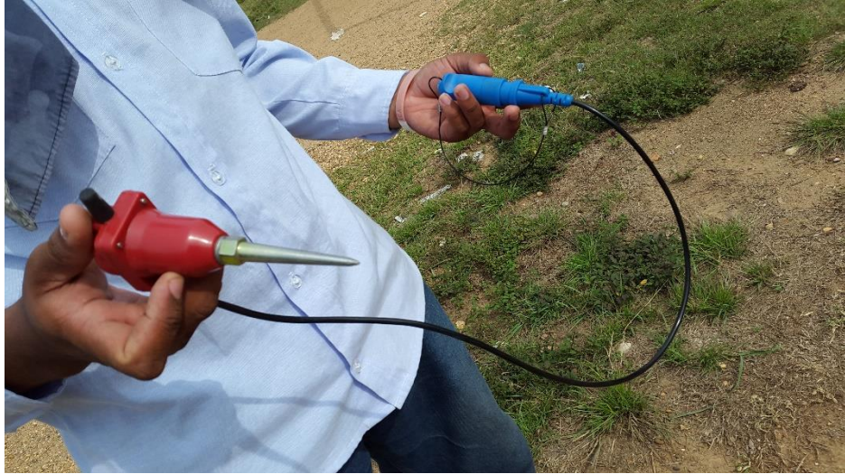
Figura 54. Geófono con su respectiva conexión a la línea (amarillo)
