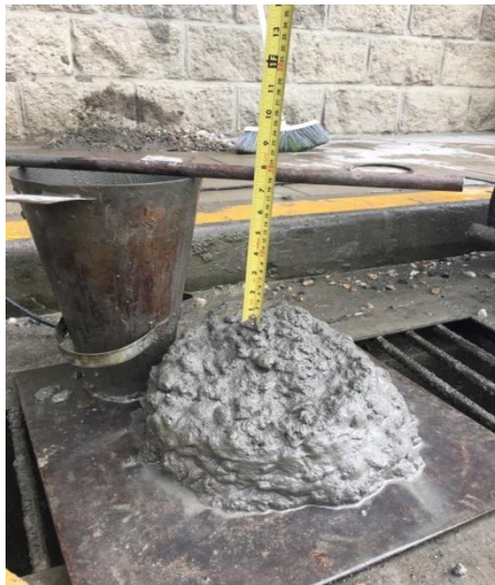
Figura 17. Registro fotográfico de toma de asentamiento para la implementación de nueva materia prima. Fuente: PREVESA S.A.S
