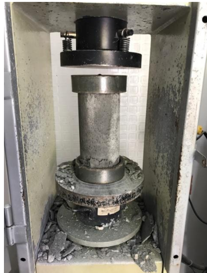
Figura 4. Cilindros fallados a compresión. Fuente: Autor.
