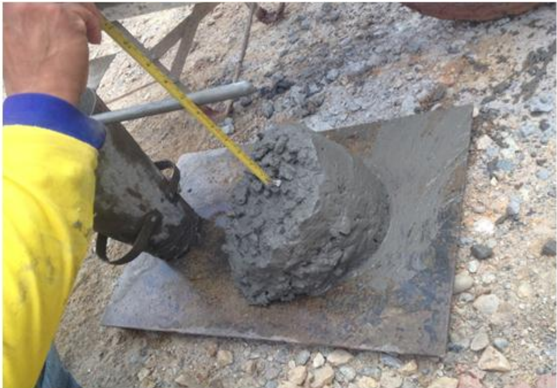
Imagen 6. Toma de asentamiento NTC 396 [5]
