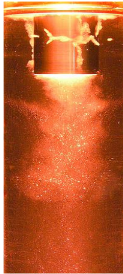
Figura 1. Cavitación ultrasónica, Fuente: Hielscher Ultrasound Technology
