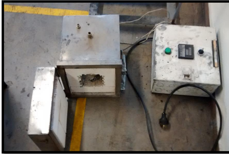
• Figura 7. Horno de secado, Fuente: Autores del proyecto
