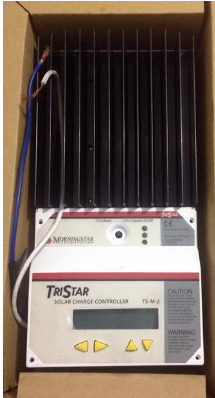
Figura 15. Controlador solar usado para los registros de potencia.
