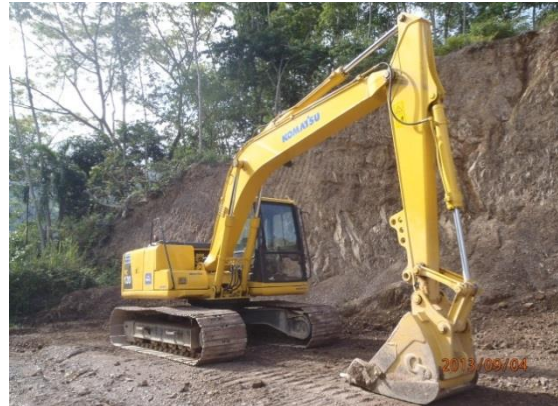
Figura 25.: Maquina encargada del corte y cargue de recebo
