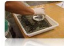
4) Agregar el 5% del peso de la masa en agua, de manera distribuida.
