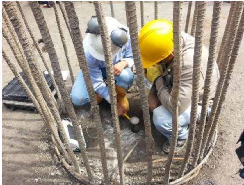
Figura 23. Aplicación de los golpes para generación de la onda de propagación a lo largo del pilote.
