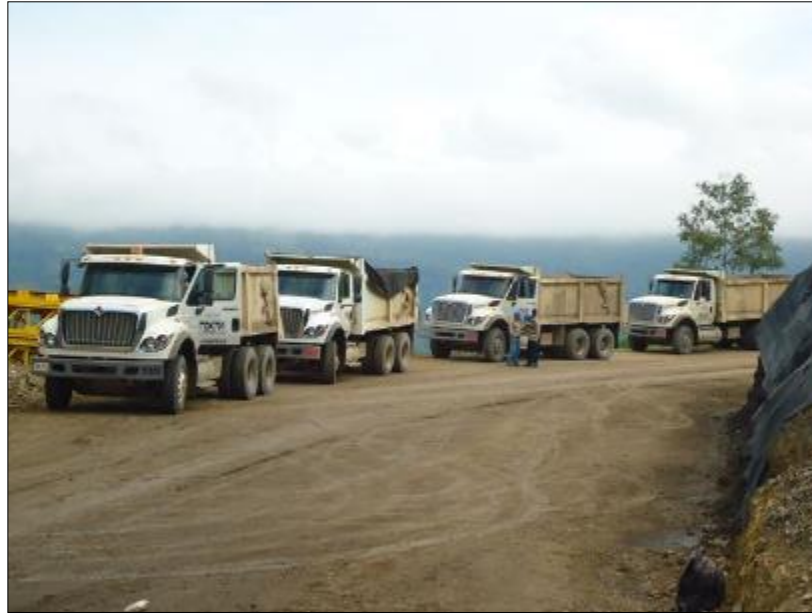
Figura 5. Tren de Carga preparado para el Puente NNV
